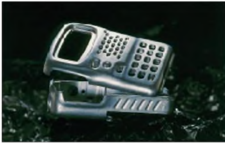
Sein Druckgußgehäuse macht das VX-5R sehr robust. Das Testgerät überstand damit einen Sturz aus 1,2 m Höhe auf Zement – mit Kratzern, aber voll funktionsfähig.
