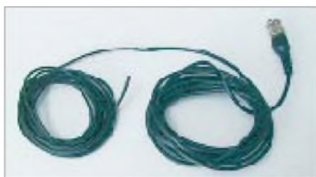
Die mitgelieferte Wurfantenne: rechts die 3 m Koaxialkabel-Zuleitung, links die „aktiven“ 3 m
