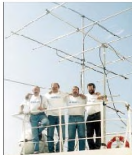
Die vier „Seefahrer“ Matti, DK5KK, Gun, DL8CMM, Wolf, DL1UU, und Ulli, DG0CAL (v.l.n.r.), nach überstandem Sturm auf dem backbordseitigen Podest, das 2 x 11-Ele.-Yagis für 2 m und zu diesem Zeitpunkt die 5-Ele.-Yagi für 6 m trug. In der Mitte eine 21-Ele.-Yagi für 70 cm.
