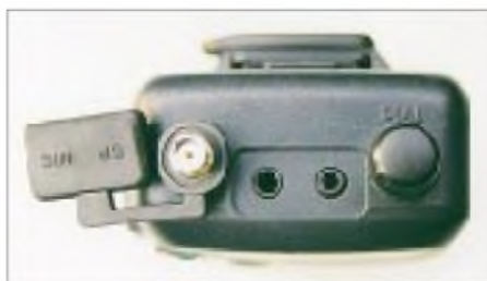
Eine SMA-Antennenbuchse und zwei Klinkenbuchsen zieren die Oberseite des Geräts. An den Stereo-Klinkenbuchsen lassen sich notfalls auch Mono-Stecker einstecken.
