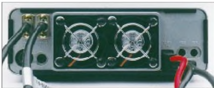
Die Rückfront wird von den beiden parallel arbeitenden Lüftern bestimmt. Außerdem fanden dort noch vier Buchsen Platz.
