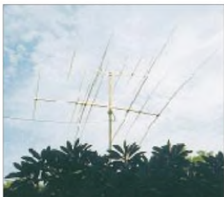
Die Yagis bei TL5A (Force 12C4 für 10 bis 40 m und 5-Element-Tonna für 6 m) auf dem 12-m-Mast, der sich in TL8GRs Garage fand.
