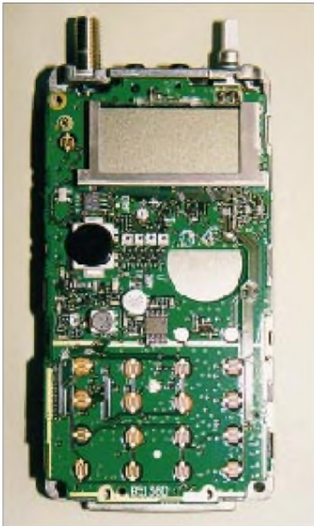
Ein Blick ins Innere des IC-T81E, hier auf die Frontleiterplatte mit Wipptaste und Mikrofonkapsel. Wegen der durchgängigen Bestückung mit winzigsten SMD-Teilen fällt die Bestimmung einzelner Baugruppen schwer. Die gesamte Schaltung findet auf nur zwei doppelseitig bestückten Platinen Platz. Fotos: Autor
