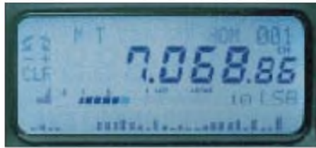
Das Spectrum Scope stellt die Aktivität unter- und oberhalb der eingestellten Frequenz als (von der jeweiligen Signalstärke abhängig) verschieden hohe Balken dar. Bei CW und SSB beträgt der Kanalabstand 2,5 kHz. Mit je 15 Kanälen auf jeder Seite überblickt man so in etwa 7 s einen Bereich von \pm 37,5 kHz. Das Icon links zeigt die RIT und darunter auch als „Dreieck“ deren Ablage (100 Hz/Linie, bis max. 700 Hz) an.
