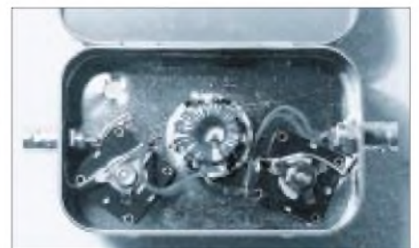
Bild 3: Ansicht des fertiggestellten p-Filters in einer Apothekenschachtel. Die Beschriftung erfolgte per Laserdrucker und selbstklebendem Ordner-Label. Fotos: DL2LUX
