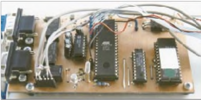
Bild 6: Die fertige Zusatzleiterplatte DSK-Loader. Links die zwei seriellen Schnittstellen, in der Mitte befindet sich der Mikrocontroller, rechts auf der Leiterplatte befindet sich der EPROM mit der abgespeicherten Filterkurve.
