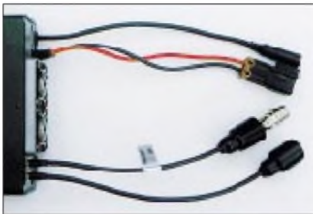
Um die Gehäusegröße zu verringern, wurden die vier weiteren Buchsen an das Ende von „Schwänzen“ verlegt.
