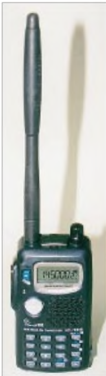
Frontansicht des IC-T81E. Nur die ungewöhnlich dicke Antenne weist darauf hin, daß sich im Gehäuse der Größe eines Monobanders mehr als zwei Bänder verbergen; insgesamt sind es vier!
