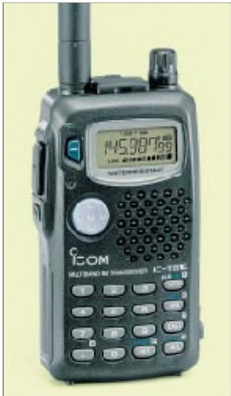
Frontansicht des IC-T81E. Nur die ungewöhnlich dicke Antenne weist darauf hin, daß sich im Gehäuse der Größe eines Monobanders mehr als zwei Bänder verbergen; insgesamt sind es vier!
