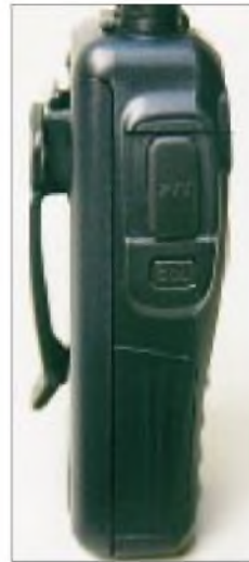
Im Profil ist das Gehäuse sehr schlank. Unter der großen, angenehm zu bedienenden Sendetaste liegt die Rauschsperrtaste.
