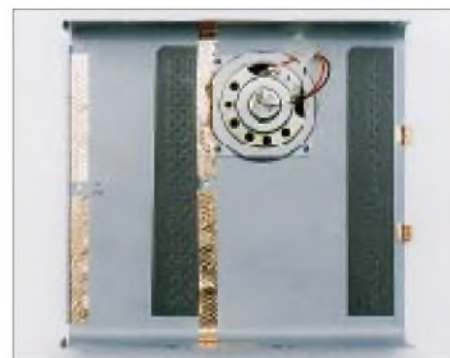
Auf die Abdeckbleche sind zur besseren internen Abschirmung noch Kupferflächen aufgeklebt.
