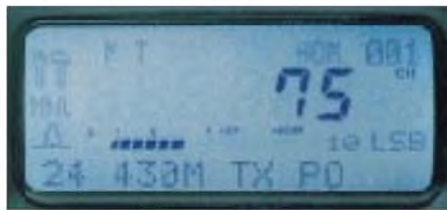
So sieht die Einstellung eines Parameters, hier der Maximalleistung auf 70 cm im Menüpunkt 24, aus.
