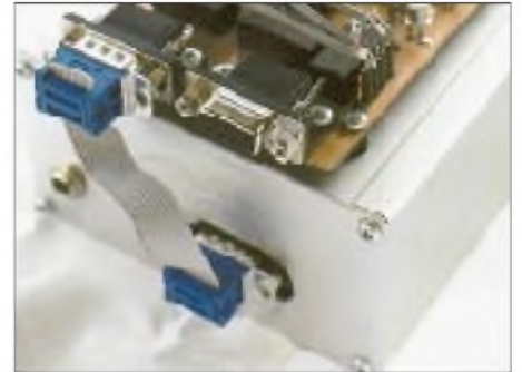
Bild 7: Das DSP-Kit ist in ein Aluminiumgehäuse eingebaut. Die Ladung der Software erfolgt über Brücken-Flachkabel. Der PC wird an die zweite Schnittstelle meiner Baugruppe angeschlossen. In Schalterstellung 0 des Programmwählschalters wird das serielle Schnittstelle durchgeschleift. Links die Buchse der 12-V-Stromversorgung. Fotos: DL4JAL
