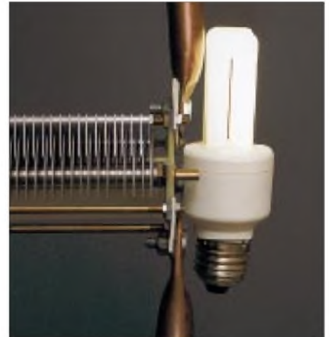
Bild 4: Keine Hexerei, sondern „greifbare“ Hochfrequenz – Magnetantenne im Resonanzfall
