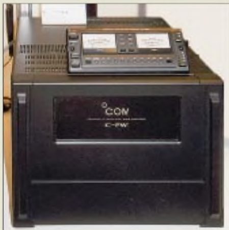
Icoms Power-Würfel hat ein abgesetztes Bedienteil, wiegt nur 25 kg und gibt 1 kW Dauerstrich-Output ab.
