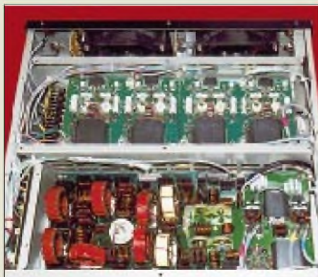
Bei Yaesus „Quadra“ sind PA und Netzteil in zwei getrennten 410 mm x 135 mm x 439 mm großen Einzelgehäusen untergebracht.
