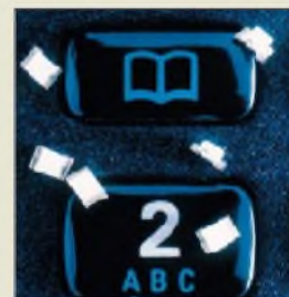
Weiße Single-Chip-LED im Vergleich zu den Tasten eines Telefons
