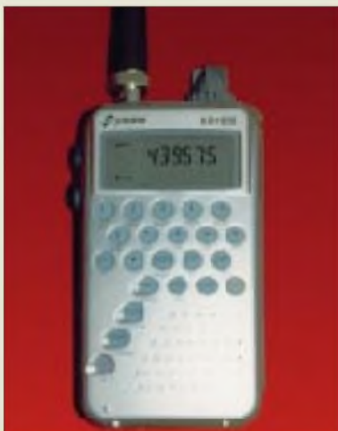
Lückenlos von 0,2 bis 2.200 MHz in den Betriebsarten AM, FM und W-FM arbeitet stabs neuer Scanner XR-1800, der zudem über einen integrierten Descrambler verfügt.
