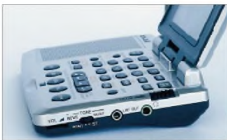
An der rechten Gehäuseseite finden sich neben der Lautstärkeregelung und einer Tonblende auch Ausgänge für Mitschnitt (fester Ausgangspegel) und Kopfhörer.
