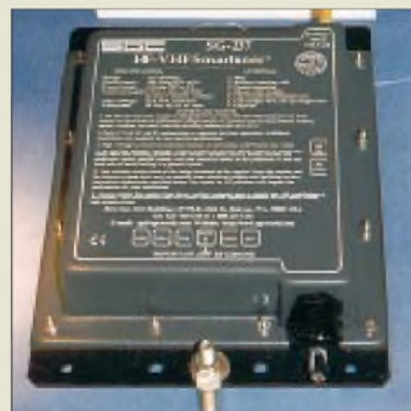
100 W SSB verkraftet dieser 1,8-bis-54-MHz-Minituner von SGC, den es bei WiMo auch als bestücktes Modul ohne Gehäuse gibt.
