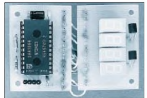
Bild 13: Die beiden Platinen des Displays im aufgeklappten Zustand
