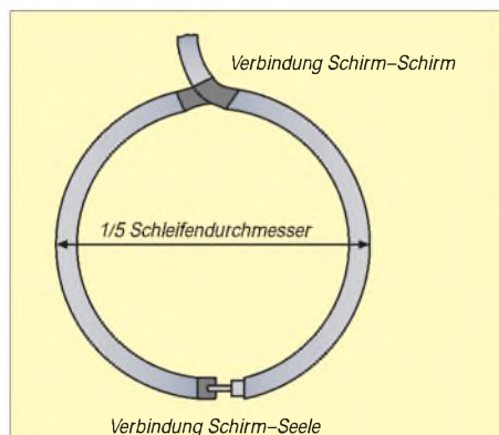
Bild 9: Herstellung der Einkoppelschleife aus Koaxkabel
