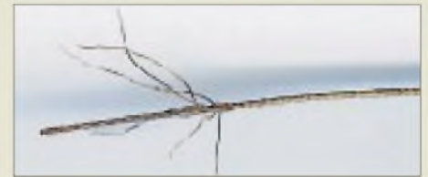
Die 0,85 mm starke Antennenlitze von Titanex verbindet hohe Zugfestigkeit von Edelstahl (90 kp) mit den guten HF-Eigenschaften von Kupfer und wiegt nur 350 g pro 100 m.
