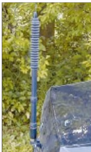
Ein an einer Kofferraumklappe befestigtes ATAS-100. Unter der ziehharmonikaförmigen Gummimanschette befindet sich die variable Spule des Abstimmsystems. Oben der nach Lösen einer M4-Schraube abnehmbare Edelstahl-Strahler
