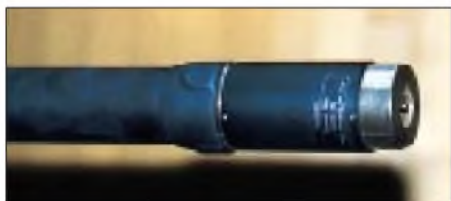
Der Anschluß des ATAS-100 erfolgt über eine PL-Schraubverbindung.
