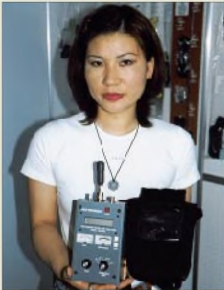
Während dieses universelle Antennenmeßgerät MFJ-259B alias Vectronics 584B – hier am Stand von CSR – von 1,8 bis 170 MHz arbeitet, soll der Nachfolger MFJ-269 auch noch das 70-cm-Band überstreichen.
