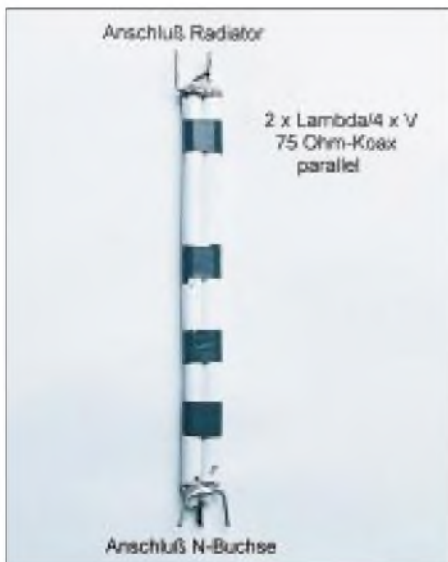
Bild 7: Fertige Anpassungsleitung vor dem Einbau
