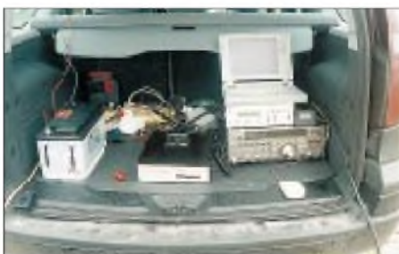
Das Mobilshack: Akkus, 200-W-PA, darauf Vorverstärker, Notebook mit OH5IY-Software, JUDSP3 (Prototyp von DL9AN), DCF77-Uhr und FT-736R; die Maus ist umgebaut und dient zum „Burst-Fangen“.
