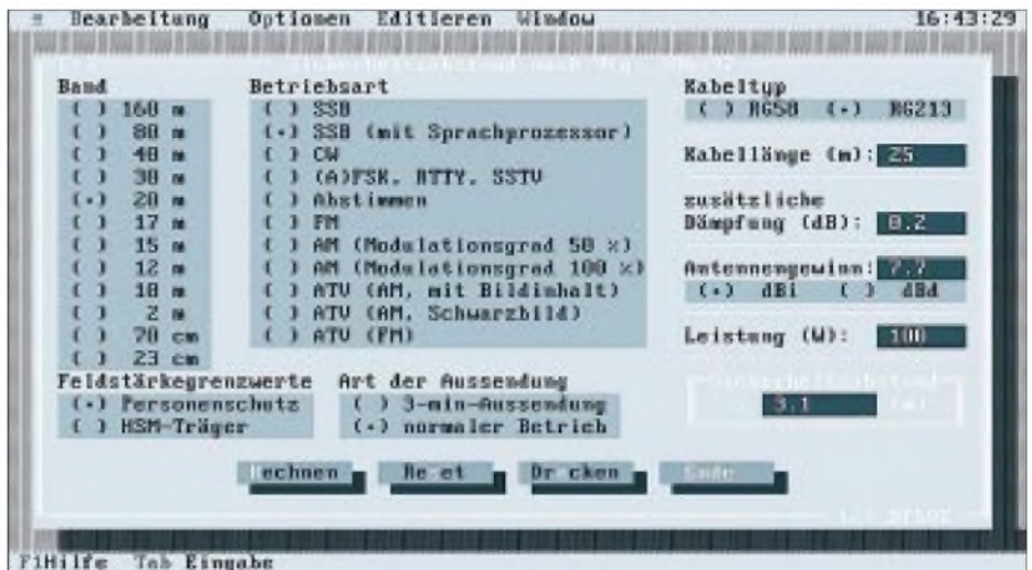
Bild 3: Arbeitsfenster zum Berechnen des Sicherheitsabstandes nach Vfg. 306/97 für eine Anwendung im 20-m-Band analog [1]. Es ist zu beachten, daß Hersteller in den USA den Antennengewinn auch bei Yagis häufig in dBi angeben.
