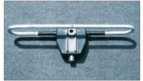
Bild 2: Der WiMo-Faltdipol mit „Posaumentchnik“, zum Abgleich veränderbar
