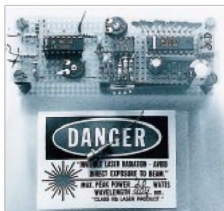
Bild 7: Strahlungsindikator mit Batteriefach und Impulsdioden Fotos: Autor
