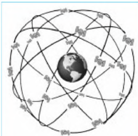
Bild 1: 24 Satelliten kreisen auf sechs, jeweils um 60° gegeneinander geneigten Bahnen um die Erde.
