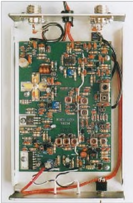
Bild 2: Blick von oben in das geöffnete Gerät; oben links das aufgerollte 4"-Koaxstück; an der Buchse oben rechts der Dummy und das 8" lange Koaxkabel
