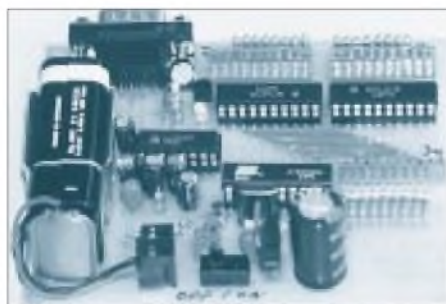
Bild 6: Die I/O-Karte ist schnell bestückt und für Batteriebetrieb vorgesehen.
