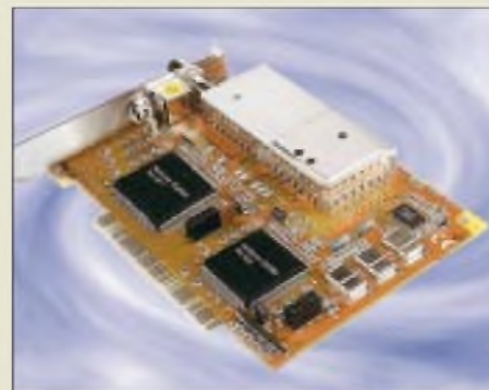
Der Einsatz von Kabelmodems, hier eine Baugruppe des „Nemo“ Kabelmodem-Systems von NetGame, ermöglicht es Kabelbetreibern, Hochgeschwindigkeits-Internetzugänge für private Wohneinheiten und kleine Büros bereitzustellen. Foto: NetGame
