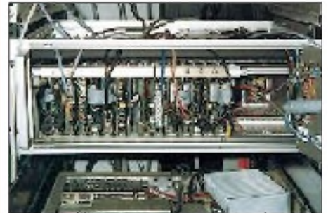
Blick ins Innere des RMNC von DB0DAR. Der Kleinzellendigipeater auf dem Dach des Institutes für anorganische Chemie an der TH Darmstadt versorgt seit 1993 die umliegenden Gemeinden.
