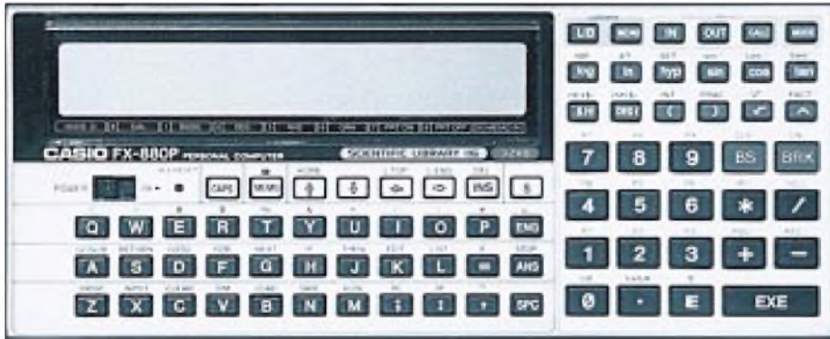
Bild 1: Der Casio FX850/880 ist unter Technikern weit verbreitet und bietet sogar eine serielle Schnittstelle für die Kommunikation mit der „Außenwelt“.
