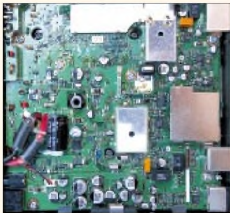
Bild 7: Blick auf das SMD-dominierte Innenleben des IC-2800H
