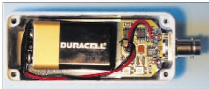
Bild 1: Innenleben des Leistungsmeßgeräts PWRM1; Kernstück ist der IS AD8307. Rechts im Bild sind die Abschlußwiderstände unmittelbar an der BNC-Buchse zu erkennen.
