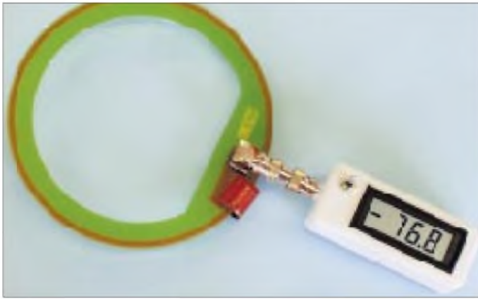
Bild 2: Die H-Feld-Sonde HFS1, hier direkt am Feldstärkemeßgerät angeschlossen. Für einen abgesetzten Betrieb der Sonde darf das Verbindungskabel nicht länger als \lambda/20 der höchsten Betriebsfrequenz sein und sollte aus doppelt geschirmtem, dämpfungsarmem Material wie RG-223 o.ä. bestehen.
