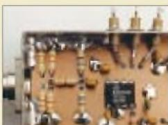
Der universelle IS AD 8307 ermöglicht den einfachen Aufbau eines Milliwattmeters.
