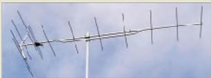
Solide aufgebaut und mit Unterzug; dadurch für Portabelbetrieb und ortsfeste Montage geeignet.
