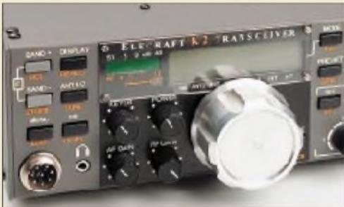
K2 – der QRP-Bausatz der Superlative; besonders hervorzuheben ist die europäischen Verhältnissen angepasste Großsignalfestigkeit des Empfänger-eingangsteils
