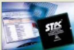
Herzstück dieser IS ist ein 64-Bit/100-MHz-Prozessorblock, der u.a. einen 64-Bit-DRAM-Controller, einen beschleunigten 64-Bit-Videocontroller sowie einen 32-Bit-x86-Prozessor der fünften Generation enthält.
