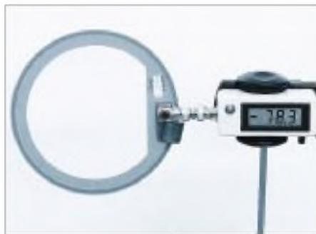
**Bild 6: Kombination PWRM1 + HFS1 mit Schnapphalterung**
