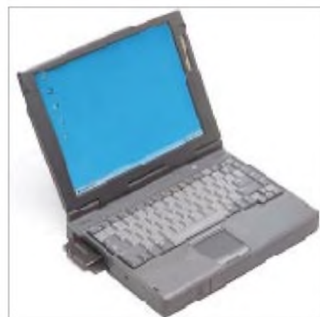
Bild 2: Eine einfache Einschubkarte macht den Notebook zum „Funkterminal“.
