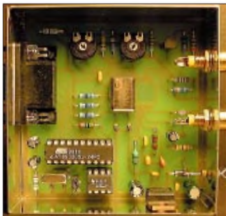
Bild 7: Fertig bestückte Platine, in einem Standard-Weißblechgehäuse untergebracht
