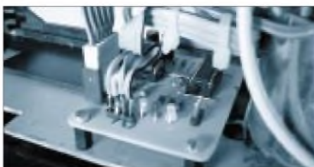
Bild 4: Blick von oben auf die Platine. Die grüne LED zeigt an, daß nach rechts gedreht wurde.
