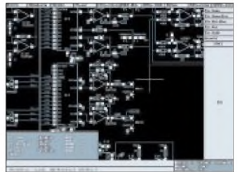
Bild 2: Durch die vollständige Integration von Schaltplan- und Layoutmodul ermöglicht CADCOM-ADVANCED automatisches Forward- und Back Annotation [W2].
