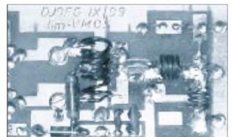
Bild 10: Blick auf den Ausgangsschwingkreis L1/L2 und die Draindrossel Dr
