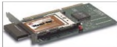
Bild 6: Die Lucent WaveLAN ISA-Karte wird auf einen ISA-Kartenträger gesteckt.
