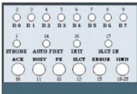
Bild 2: Mögliche Frontplattengestaltung des LPT-Testgeräts
