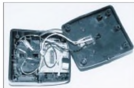
Bild 9: Geöffnete Ladestation mit kompletter Nachrüstung
