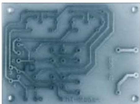
Bild 22: Die fertige Platine. Hier wurde Transparentpapier als Belichtungsvorlage benutzt.
