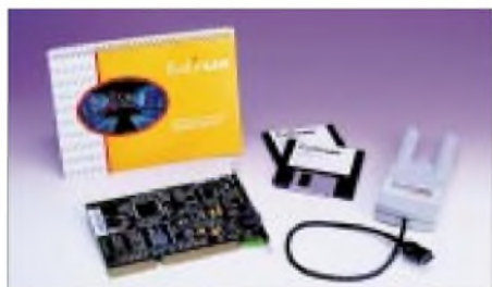
Bild 10: Das 5,8-GHz-Übertragungssystem von RadioLAN gibt es als ISA-Karte für den PC.
