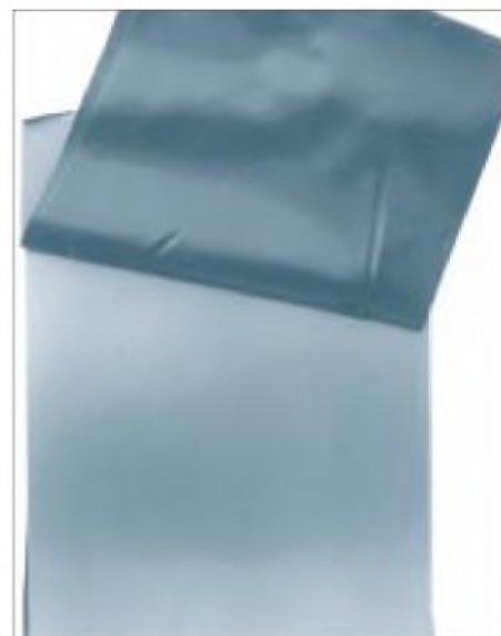
Bild 24: Die Schutzfolie wird abgezogen, die lichtempfindliche Schicht liegt jetzt frei.
