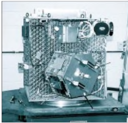
Die JAWSAT-Plattform, im Vordergrund ist OPAL angeflanscht
