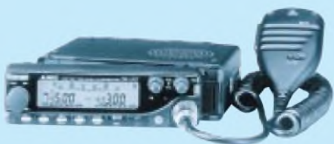
Bild 4: Alincos Mobilduobander DR-610 ist gleichwohl eine vernünftige Wahl für stationären Betrieb. Ein kräftiges Netzteil der 20-A-Klasse ist Bedingung – 10/12-A-Geräte versagen später (!) bei voller Sendeleistung.
