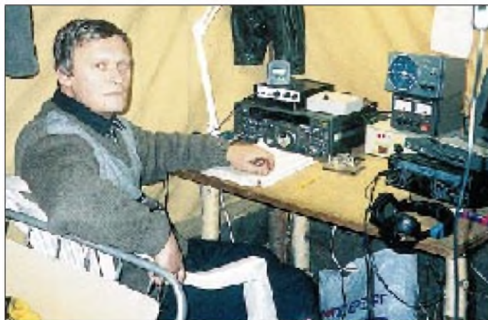
RU1AA an der EME-Station von R1MVZ auf Malyi Vysotskij Island (KP40GP). Die Ausrüstung bestand u.a. aus FT-736R, Mirage B1016, 2 x GU93b sowie diversen Vorverstärkern.
