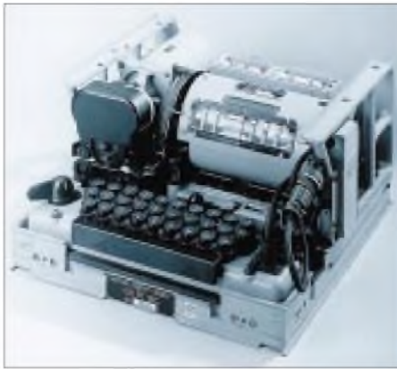
Bis weit in die 80er Jahre hinein wurde dieses Chiffriergerät mit der Typenbezeichnung KLB-7 von der NATO eingesetzt. Deren Funkfernsehreibnetze sind nach wie vor über den gesamten Bereich der Kurzwelle verteilt.
