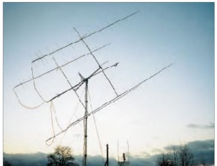
Als 2-m-Antennenanlage von R1MVZ auf Malyi Vysotskij Island fungierte eine 4 x 14-Ele.-Crossyagi nach SM5BSZ. Fotos via DK3WG
