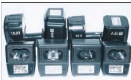
Bild 11: Ladestationen mit günstigen Abmessungen für die Nachrüstung
