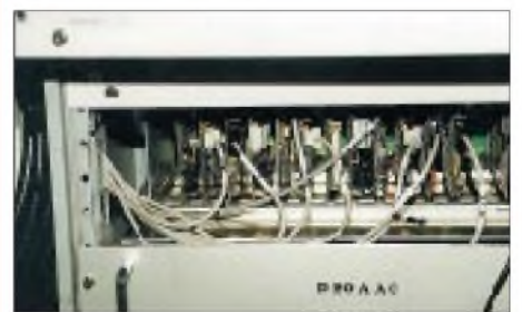
Blick ins Innenleben von DB0AAC: Die einzelnen RMNC Kanalrechner bilden das Herz des Digipeaters. Im Digi werden verschiedene Karten eingesetzt: RMNC II mit externem Modem, HB9ATU und RMNC III-Karten mit integriertem Modem. Zusätzlich sind eine Masterkarte, eine Resetkarte und das 5-V-Netzteil im 19"-Einschub untergebracht.
