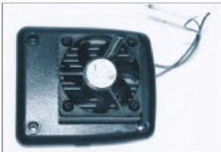
Bild 8: Gehäuseunterteil mit aufgesetztem Pentium-I-CPU-Cooler
