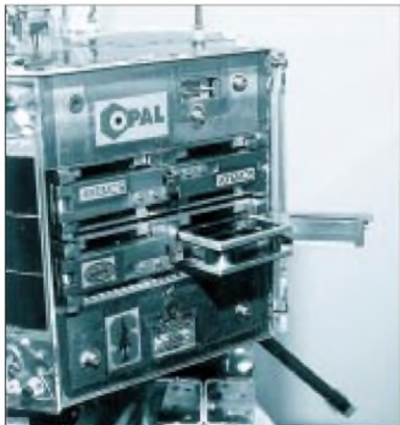
OPAL mit den Schächten für die NanoSats (oben Artemis, unten rechts Stensat)
