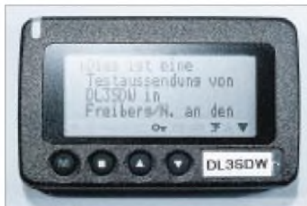
Bild 4: Eine Kurzmitteilung via SAMS; das POGSAG-Protokoll läßt die Übertragung beliebig langer Nachrichten zu, viele Geräte speichern aber nur bis zu 120 Zeichen.
