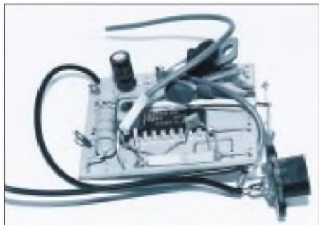
Bild 7: Leiterplatte zum Einbau vorbereitet
