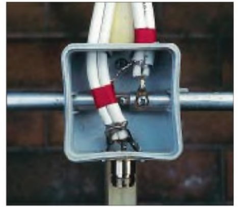
Bild 11: Eigenbauvariante einer Dipolanschlußdose unter Verwendung einer Aufputz-Verteilerdose.
