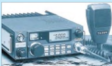
Bild 3: Darf's ein wenig mehr sein? Noch gibt es den FT-290RII vereinzelt – ein tragbares Gerät, das batteriebetrieben in CW, FM und SSB 2,5 W abgibt und obendrein durch eine angeflanschte Endstufe zu erweitern ist.
