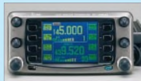
Vollwertige Twinbander wie dieser IC-2800H sind oft an doppelt vorhandenen Lautstärke- und Squelch-Stellern erkennbar. Werkfoto
