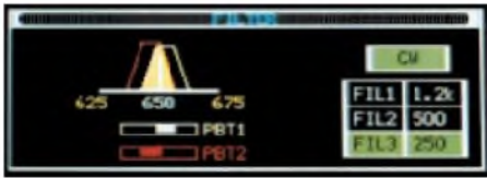
Bild 11: Die Bandbreitendarstellung hat eine großzügige und anschauliche Ergänzung gefunden: Sie zeigt bei CW sogar die auf die aktuelle Ablage (Pitch) bezogenen Frequenzen.
