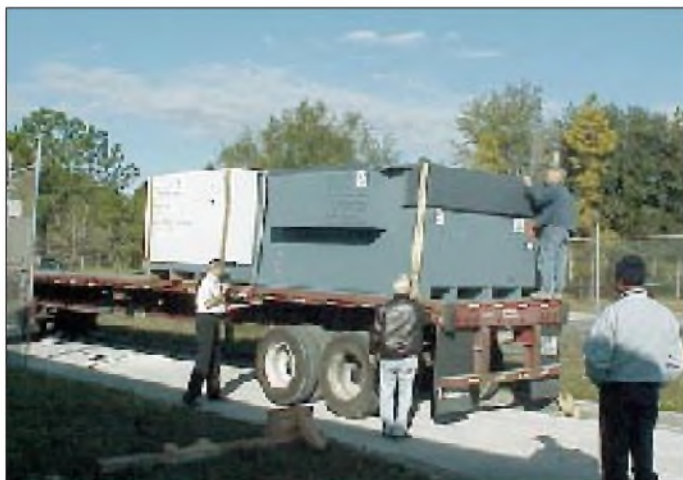
AMSAT-Phase 3-D und der SBS-Adapter werden zur Fahrt nach Atlanta verladen. Die Transportmasse beider Container betrug etwa 2600 kg.
