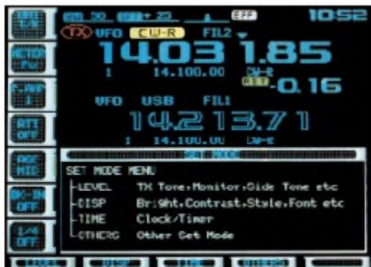
Bild 2: Gut Ding will auch sinnvoll bedient sein. Die bewährten Softkeys ebnen zusammen Menüs und mit längeren Tastenbetätigungen den Weg dazu. Hier das Einstiegsmenü unter Display-Farbvariante A.
