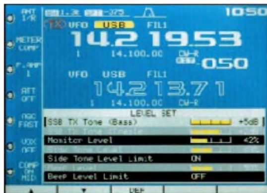
Bild 2: Gut Ding will auch sinnvoll bedient sein. Die bewährten Softkeys ebnen zusammen Menüs und mit längeren Tastenbetätigungen den Weg dazu. Hier das Einstiegsmenü unter Display-Farbvariante A.
