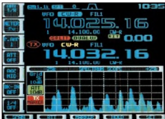
Bild 14: Full Power für den DXer. Mit Dualwatch, Quick-Split und XFC stehen ihm neben den DSP-Annehmlichkeiten zweckmäßige Werkzeuge zur Verfügung. So zeigt die rote Linie im Monitor z.B. die Sendeablage.
