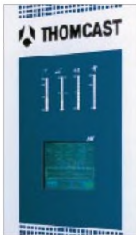
Bild 5: Schlicht wie seine Außenansicht auch das Bedienteil des neuen Mittelwellensenders als berührungssensitives Display
