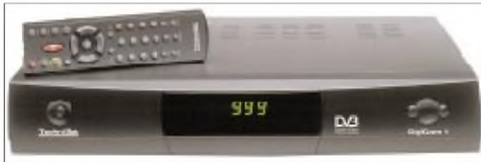
Beispiel eines sogenannten FTA-Digitalreceivers, der keine Erweiterung für Pay-TV-Dekoder vorsieht (Technisat DigiCom 1)
