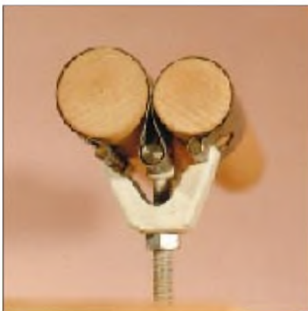
Bild 2: Universell einsetzbare Klemmverbindung für Rohre und Stangen Foto: Schäfer
