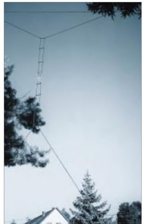
Bild 8: Die zwischen zwei Bäumen aufgehängte Doppelquad bei DK8CK; deutlich sind die Abstandshalter zu erkennen.
