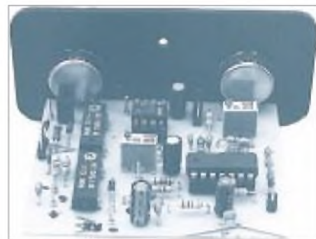
Bild 37: So sieht eine fertige Platine unseres Projektes aus. Sie wird durch die beiden Potis an der Frontplatte gehalten, im Gehäuse unterstützen bereits vorhandene Dorne den Halt. Die Platine der Stromversorgung wird durch Abstandsbolzen M3 gehalten.
