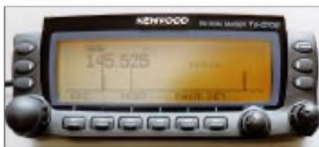
Bild 7: Das Spektrumdisplay umfaßt bei brei-tester Einstellung das gesamte 2-m-Band im 12,5-kHz-Raster. Ein Durchlauf nimmt nur 11 s in Anspruch – das ist Spitzenklasse!
