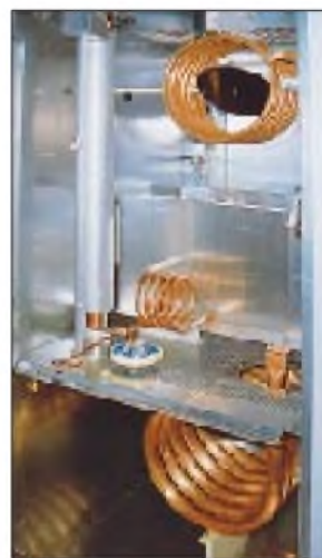
Bild 2: Netzteil des 100-kW-Transistorsenders; unten links die Gleichrichtereinheit, dahinter der Netztransformatoren, statt hoher Spannungen gibt es hier erhebliche Ströme.
