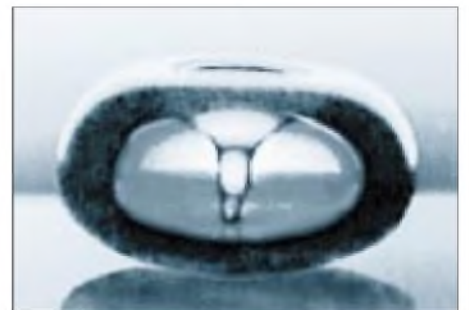
Bild 2: Bei der Implosion einer Kavitationsblase wird eine große Energiemenge frei.
