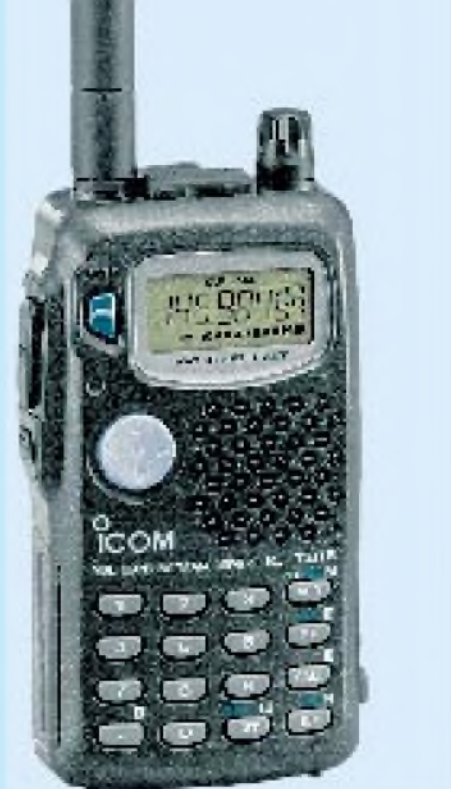
Das Multibandhandy IC-T81E bringt die Bänder 6 m, 2 m, 70 cm und 23 cm von Hause aus mit. Zu richtigem Leben erwacht es indes erst durch zweckmäßiges Zubehör.
