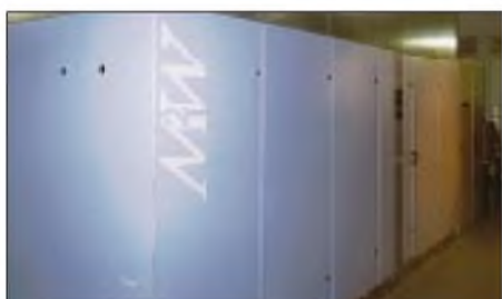
Bild 1: Unspektakulär: Der neue transistorsierte 100-kW-Mittelwellensender beansprucht nur eine Fläche von 5 m x 1,1 m.
