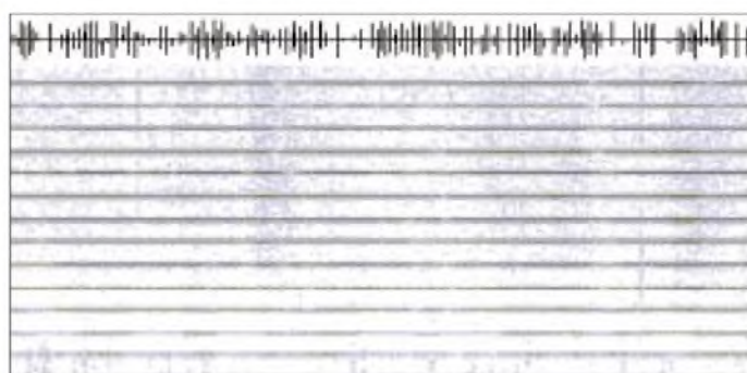
Bild 2: Der „Wasserfall“ zeigt den zeitlichen Verlauf in der Horizontalen; ganz oben der Austastzyklus mit einem Abstand der horizontalen Streifen entsprechend 50 Hz.
