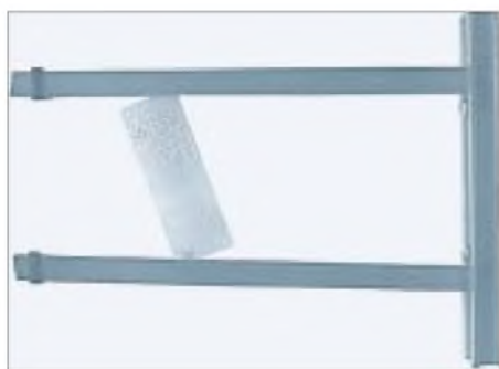
Bild 36: Das diagonale Einspannen kleiner Platinen ergibt bessere und gleichmäßigere Ätzungen.
