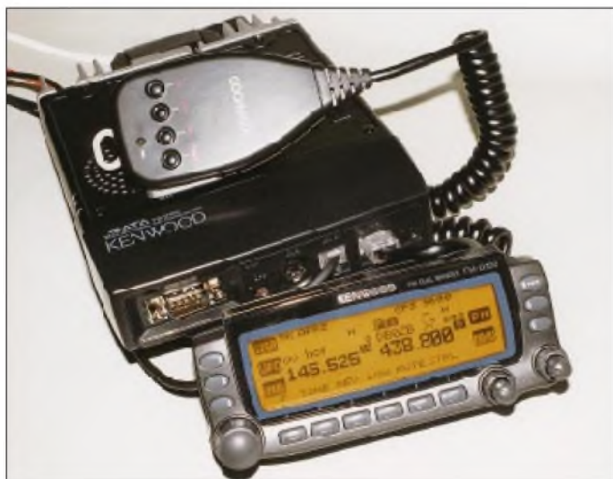
Bild 1: Die 180 g schwere Bedieneinheit ist als mechanisch vollständig vom Hauptgerät getrennte Baugruppe ausgeführt. Sie ist nur über ein vierpoliges, hochflexibles, 3 m langes und somit reichlich bemessenes Kabel mit diesem verbunden.
