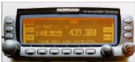
Bild 6: Das Display ist bernsteinfarben illuminiert; jede Taste ist durchleuchtet. Kurzbezeichnungen für die jeweils gültigen Tastenfunktionen erleichtern die Bedienung.
