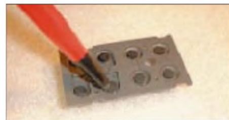
Bild 3: Vor dem Auftragen der Lösung werden die Gummiflächen mit einem Glasfaserpinsel angeraut.
