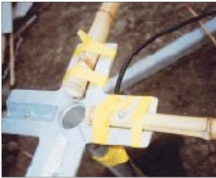
Bild 3: Aluminiumkreuzstücke [3] mit Befestigung der Bambusrohre Fotos: DL7VEE
