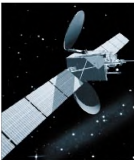
ARTEMIS ist ein moderner und vielseitiger Kommunikations-Experimentalsatellit der ESA, der für Tests zahlreicher künftiger Technologien eingesetzt werden soll. Neben Navigationssatelliten-Techniken dient er unter anderem auch Laserfunkverbindungen im Weltall. Er soll noch in diesem Jahr gestartet werden. Bild: ESA
