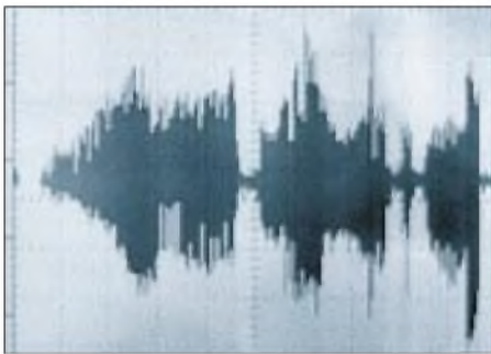
Bild 1: Das Wort „Funkamateur“ als Sprachzeitsignal, welches zu einer Merkmalschablone verarbeitet werden soll...
