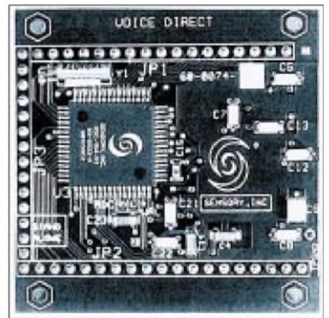
Bild 4: Ansicht des Spracherkennungsmoduls mit dem IC RSC164. Oben links befindet sich der Quarz. Weitere Bauteile und ICs findet man auf der Rückseite.
