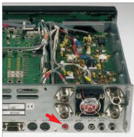
Bild 12: Moderne Transceiver, hier FT-847, verfügen über eine separate DATA-Buchse (5. v.r.) für externen NF-Zugriff.
