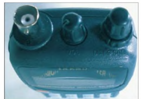
Gern gesehen: Antennenanschluß in BNC-Norm. Der Squelchdrehsteller liegt radial um den Hauptabstimmknopf.
