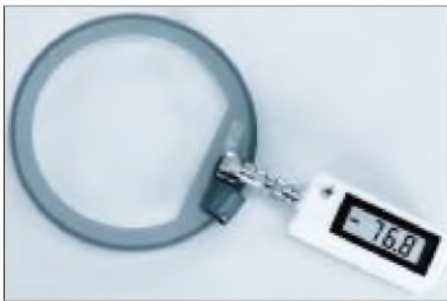
Bild 4: Magnetfeldsonde HFS1 und BNC/BNC-Adapter am PWRM1
