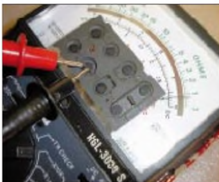
Bild 2: Der Leitgummi ist in Ordnung, wenn ein endlicher Widerstandswert im Megaohm-Bereich gemessen werden kann.
