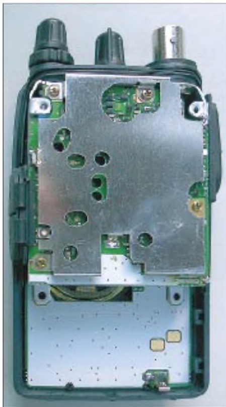
Viel Abschirmblech und winzigste Bauteile kennzeichnen den Aufbau. Fotos: Autor
