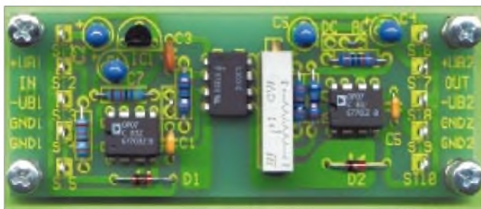
Bild 18: Ansicht der 79 mm x 30 mm großen Platine des ELV-Trennverstärkers [32]
