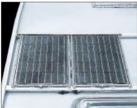
Bild 1: Flache, hochgesetzte Montage auf dem Wohnmobildach
