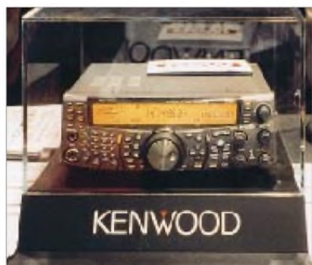
Vor der Markteinführung in den USA steht noch der Segen der FCC aus: der angekündigte KW/VHF/UHF/SHF-Allmode-Transceiver
