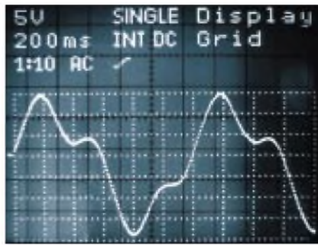
Bild 3: Typisches Detektorsignal beim Wechsel der Chiptemperatur
