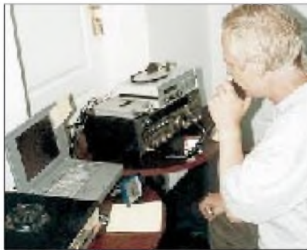
Bernd, SO9AN, während der E s -QSOs. Das Equipment: 300-W-Transistor-PA, Notebook mit OH5IY-Software, FT-736R, JUDSP2 (v.l.n.r.).
