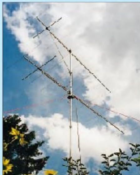
Vertikale Stockung bringt knapp 3 dB mehr Gewinn und verringert den vertikalen (Freiraum-)Öffnungswinkel; die wirksame Höhe liegt in der Mitte beider Antennen. Fotos: rd
