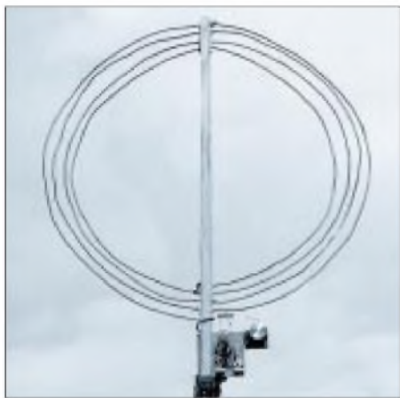
Bild 1: Diese einfache Empfangsspule mit 32 cm mittlerem Durchmesser hat es im 80-m-Band in sich.
