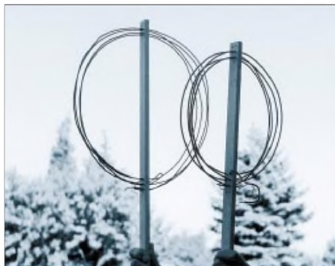
Bild 5: Zwei einfache, zweigeteilte Rahmenantennen für Masseanschluß in der Mitte
