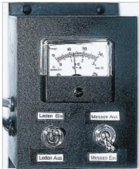
Bild 3: Ladebox mit Schaltern und Amperemeter
