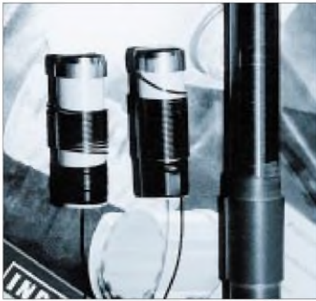
Bild 6: 10-, 20- und 160-m-Spule; an den oberen Enden sind die Metallhülsen erkennbar.
