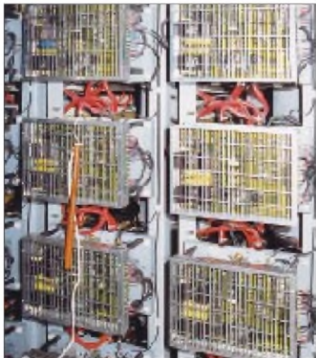
Die Modulationsstufe (Teilansicht) besteht aus 32 Halbleiter-Verstärkern.
