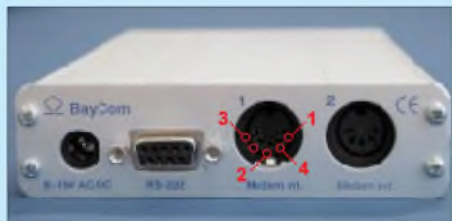
Mitgedacht: Standardbuchsen gestatten eine einfache Konfektionierung der TNC-Anschlußkabel durch den Anwender.
