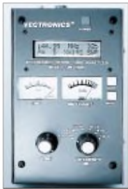
Bild 6: Den bis 170 MHz nutzbaren Vectornics 584B gibt es gleich komplett mit Diperspulen und Tragetasche.
