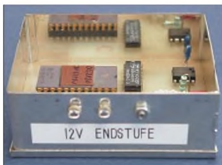
Bild 1: Dieser dank verfügbarer Leiterplatte schnell aufzubauende Rufzeichengeber eignet sich z.B. als CQ-Maschine, aber auch für Baken oder Fuchsjagdsender.
