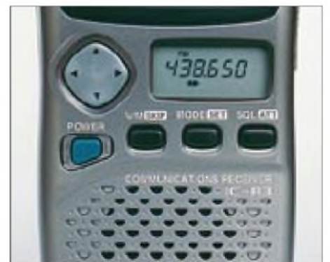
Wenige Tasten erschließen die gesamte Bedienungs Vielfalt des IC-R3. Ein kleines LC-Display gibt Auskunft über die wichtigsten Empfangsparameter.
