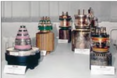
Luftgekühlte Sendetrioden und -tetroden bis 10 kW im Sender- und Funktechnikmuseum Königs Wusterhausen Foto: DL6AKC
