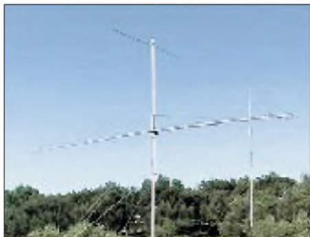
Die Antennen von Ralf, SV8/DL3GN: Dipol für 6 m, 17-El.-M 2 für 2 m und die Kurzwellen-GPA
