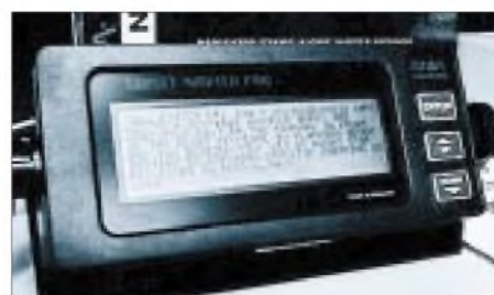
Bild 3: Der Navtex-Empfänger NASA Navtex Pro der britischen Fa. NASA Marine Ltd. stellt die empfangenen Nachrichten auf einem achtzeiligen LC-Display dar. Sein Preis liegt bei 850 DM. Fotos: Hersteller
