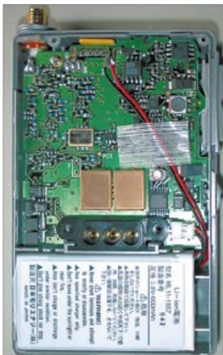
Blick ins Innere des Gehäuses. Außer dem Lithium-Ionen-Akku, unter dem der Lautsprecher liegt, den VCOs und dem 1. ZF-Filter sind nur wenig Bauteile zu identifizieren.
