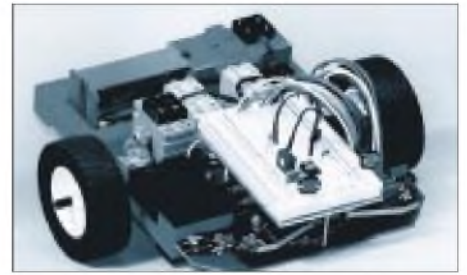
Bild 9: Das Steckboard wird direkt auf dem „Roboter-Chassis“ montiert.
