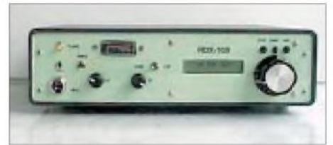
Der 9-Band-CW/SSB-Transceiver RTX 109 von Sheldon Hands aus England
