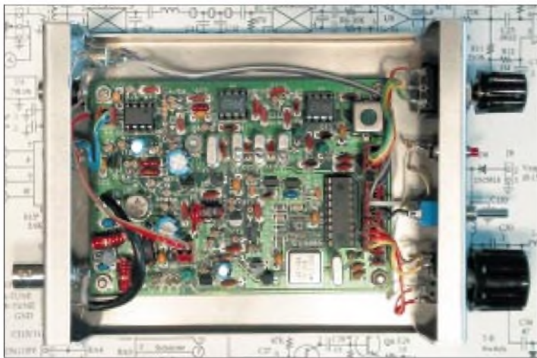
Bild 4: Blick auf einen fertig aufgebauten DSW 40. Das Muster verwendet allerdings nicht das Gehäusekit. Foto: FA
