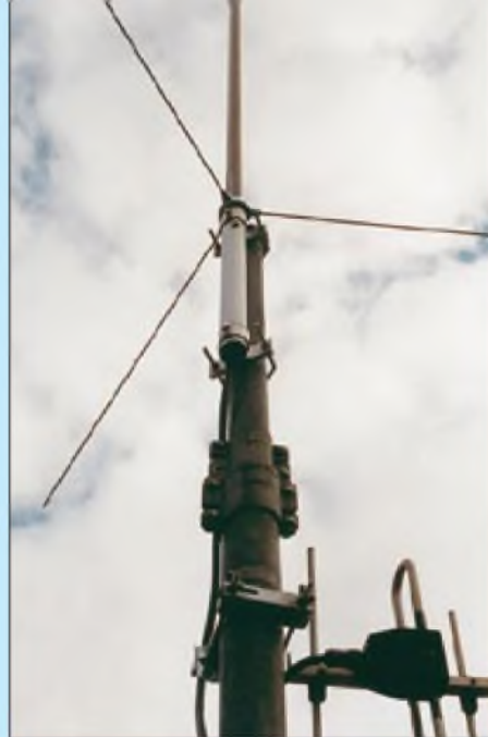
Bild 3: Für den Anfang nicht schlecht: Ein Rundstrahler für FM-Betrieb auf 2 m und 70 cm, und darunter eine fest montierte 70-cm-Yagi für Packet-Radio Foto: WiMo
