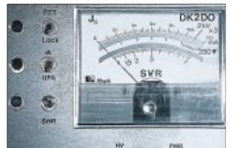
Bild 3: An der Gerätefrontplatte erfolgt die Auswahl zwischen Vor- und Rücklauf mit Kippchaltern.
