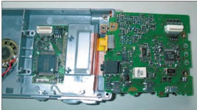
Noch weiter geöffnet findet sich die CPU-Platine neben dem durchscheinenden Display. Gut erkennbar ist das 450-kHz-Filter für die 3. ZF.
