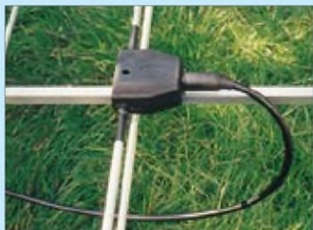
Bild 4: Die Gummikappe schützt den Stecker, während das bogenförmig verlegte Speisekabel das Wasser abtropfen läßt.
