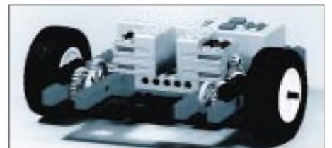
Bild 2: Für die Ausführung beliebiger Bewegungen in der Fläche erfolgt die Steuerung der Räder mit getrennten Motoren über ein Differentialtriebe.
