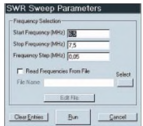
Bild 13: SWR Sweep Parameters: Eingabemaske für die Start- und Stopffrequenzen sowie die Stufung zur Berechnung einer Wellenigkeitskurve s(f). Getrennt erstellte Sweepdateien (Frequenzpunktdateien) können hier ebenfalls aufgerufen werden.
