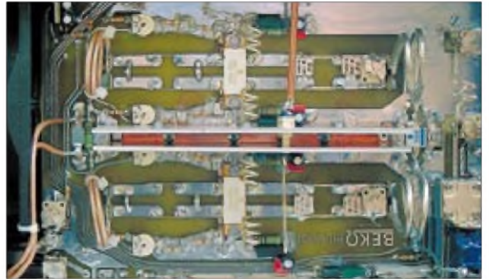
Bild 4: Innenansicht der HLV-600; links die Steuerplatte (Schutzschaltungen und Ablaufsteuerung) und Teile des Netzteils, rechts ist die Verstärkerplatte mit den beiden MOSFETs MRF-151G zu sehen.
