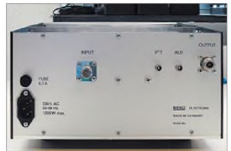
Bild 2: Die Rückansicht der HLV-600 läßt N-Buchsen für Ein- und Ausgang sowie Cinch-Buchsen für PTT und ALC erkennen.
