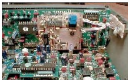
Ein nachträglich zu installierendes Audio-Notch- und Bandpaß-Filter für den K2 entwickelte Randy, WJ4P. Eine ausführliche Anleitung findet man unter http://www.elecraft.com/TechNotes/notch_filter_wj4p.htm
