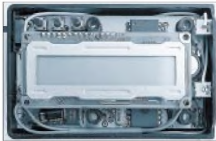
Bild 6: Das Display ist die konstruktiv größte Komponente im gesamten Gerät.
