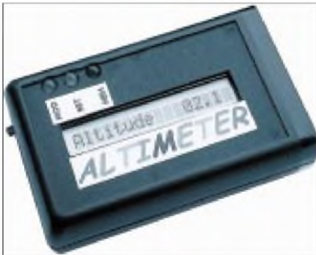
Bild 1: Unser digitaler Höhenmesser (Altimeter) mißt neben der Höhe auch Luftdruck und Temperatur. Daneben zeichnet er bis zu zehn Stunden sämtliche Daten auf und speichert sie zur Weiterverwendung auf dem PC ab.
