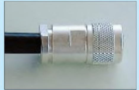
Bild 1: Aufschieben der Hülse und Festziehen mit passenden Maulschlüsseln beendet die Montage des N-Steckers UG-21STG und ähnlich aufgebauter Modelle.
