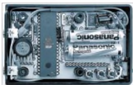
Bild 8: Die Stromversorgung wird durch zwei NiMH-AAA-Batterien realisiert.
