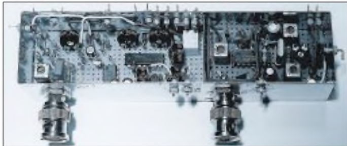
Bild 7: Der ZF-Verstärker für die AGC-Gewinnung (l.) befindet sich zusammen mit dem FM-ZF-Verstärker in einem Gehäuse.
