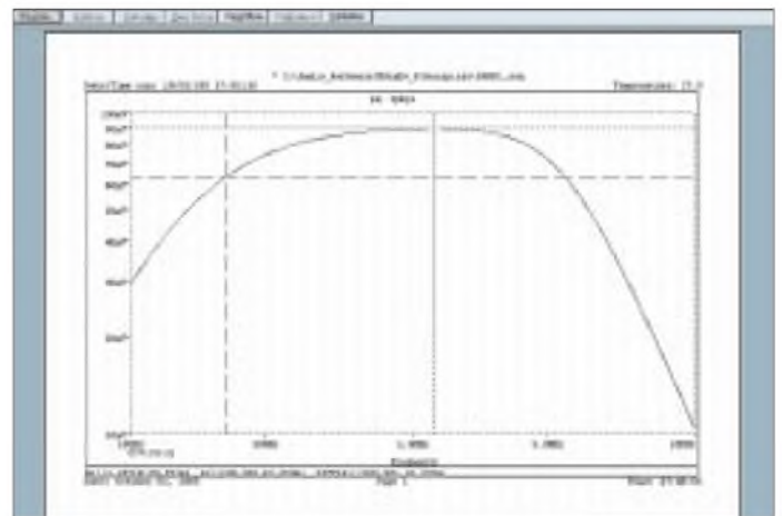
Bild 21: Screenshot der Simulation des NF-Bandpasses mit PSpice
