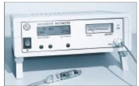
Bild 2: Das fertig aufgebaute Milliwattmeter macht einen professionellen Eindruck; im Vordergrund der den Frequenzbereich bestimmende Detektorkopf.
