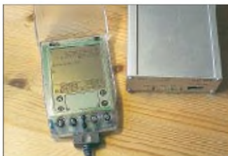
Bild 8: Verbindungsaufnahme zu einem TNC via Terminalemulation
