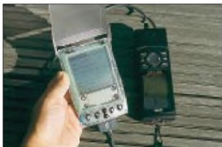
Bild 7: Palm + GPS = GPilot
