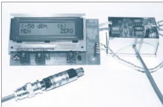
Bild 1: Die bestückten Baugruppen vor dem Einbau ins Gehäuse. Unterhalb des aufgesteckten Displays sind auf dem Prozessorboard die drei Taster zu erkennen.
