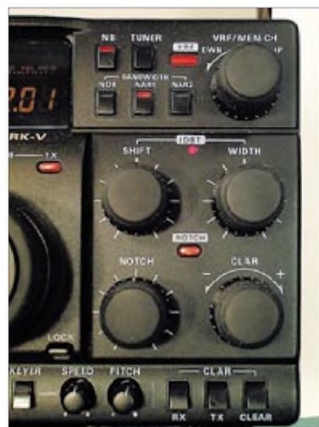
Bild 8: Die meisten weiteren Veränderungen zeigen sich im rechten Frontplattenabschnitt. Es wurde etliches vertauscht, die Störastasterbedienung wanderte bis auf den Einschalter in die Menüebene, um u.a. Platz für die minimierte ZF-Filterumschaltung (wozu auch ein 250-Hz-Filter in der 3. ZF mit einem 2,4-kHz-Filter in der 2. kombinieren?) zu schaffen. Auch das Antennenabstimmgerät hat nur noch eine Taste. Vor allem stehen jetzt zwei große, separate, griffige Knöpfe für die Bedienung der Bandbreitenverstellung zur Verfügung. Eine zusätzliche Leuchtdiode signalisiert, ob dabei zusätzlich die IDBT wirksam ist. Oben rechts schließlich avancierte der Speicherauswahlknopf (nun dafür zu drücken) zum Einstellorgan für den neuen Preselektor.
