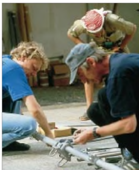
Den Aufbau einer LP5-Antenne sollte man zuvor geübt haben. Die geringe Masse, flugfreundliche Verpackung und hohe Effizienz jedoch machen diese Fünfband-Antenne der Firma Titanex zu einer hervorragenden Lösung für DXpeditionen. Fotos: DL5EBE
