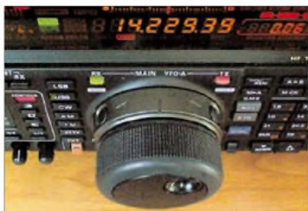
Bild 4: Der Jog-Shuttle-Knopf bekam Untermitter, links und rechts oben zwei runde Tasten für die Aktivierung von VRF (HF-Vorabstimmung) und IDBF (gekoppelte digitale Bandbreiteneinstellung). Das erlaubt während des Über-das-Band-Drehens schnellen Zugriff zu diesen wichtigen Funktionen.
