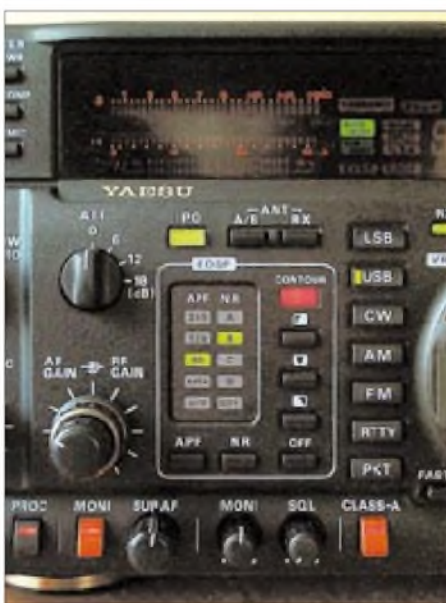
Bild 7: In dieser Frontplattenpartie dokumentiert sich zunächst die verbesserte Bedienung der DSP-Filter. Die vier DSP-Filterbandbreiten für Data sowie 60, 120 und 240 für CW sind nun bequem zugänglich, ebenso vier Grade der DSP-Rauschverminderung, die sich als durchaus genügend erwiesen. Daneben nun, bedientechnisch ja auch dazugehörig, die Tasten für die drei Kontur-Filter (früher ein Drehschalter auf der rechten Frontseite); eine Mehrfarb-Leuchtdiode zeigt dabei, welches eingeschaltet ist. Links unten ist zu erkennen, daß die Steller für die ZF-Verstärkung und die Lautstärke des Zweitempfängers vertauscht wurden. Die rechte orange Taste schaltet jetzt statt der User-Einstellung den A-Betrieb der Endstufe beim Senden ein.
