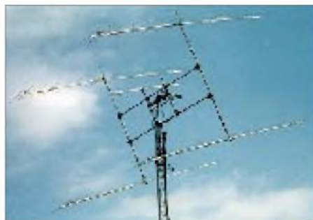
Die 4 x 17-Elemente-Gruppe von David, GM4JJJ, der vielen OMs von Aurora- bzw. EME-QSOs bekannt ist
