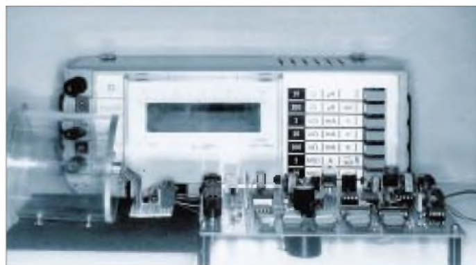
Bild 8: Mit einem Digitalmultimeter erfaßt man die Wärmestrahlung, die in die Fresnel-Linse einfällt.
