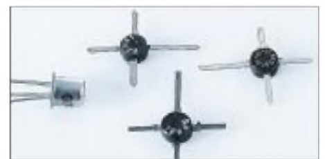
Bild 4: Links ein Germanium-Transistor aus den siebziger Jahren, daneben rauscharme Dual-Gate-FET BF981 aus den Achtzigern, wie sie für 2-m-Vorverstärker auch heute noch völlig ausreichend sind.
