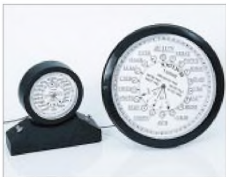
Bild 1: Musterexemplare von zur NCDXF-Bakenuhr umgebauten Quarzuhren. Anstelle des Zeigers dreht sich in der Mitte eine kreisförmige Scheibe, auf der sich wiederum für jede Frequenz ein Zeiger befindet.
