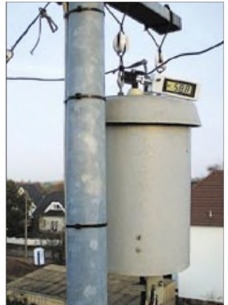
Bild 2: Meßanordnung am Einspeisepunkt der Musterantenne
