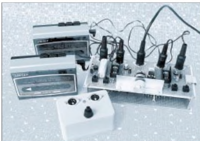
Bild 6: Mustersaufbau, als Signalquellen dienen beim Autor zwei preiswerte Walkman-Geräte. Auf die Entwicklung einer speziellen Platine wurde verzichtet. Im Vordergrund sichtbar der Impulsgeber.
