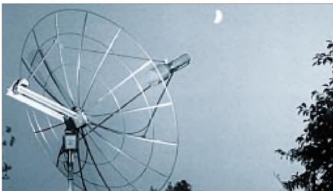
Bild 1: 23-cm-EME-Antenne von DJ9YW. Das Rauschmaß des nachfolgenden Empfangssystems beläuft sich auf 0,48 dB und repräsentiert das derzeit Machbare in diesem Frequenzbereich, vgl. a. [1]. Foto: DJ9YW
