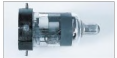
Bild 2: Die RV12P2000 stammt aus den vierziger Jahren und wurde nach dem Krieg gern in Amateurschaltungen bis in den UKW-Bereich eingesetzt. Fotos: Red. FA (2)
