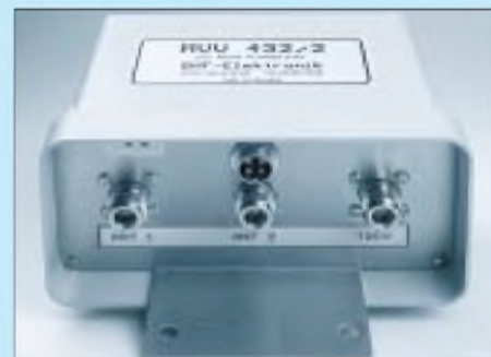
Bild 4: Dieser Mastvorverstärker für Außenmontage besitzt 0,8...1,2 dB Rauschmaß – ausreichend für terrestrischen Funkverkehr.
