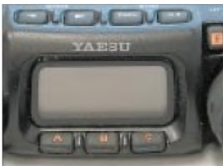
Die kleine Frontplatte zwingt, vier Tasten auf die Oberseite des Geräts zu verlegen. Unter dem Display die drei Softkeys.
