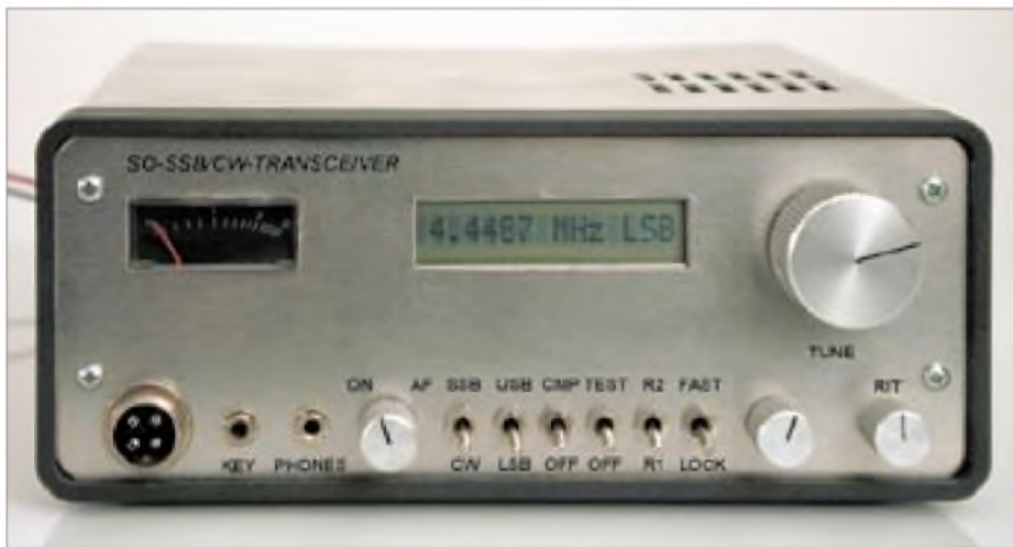
Bild 1: Frontansicht eines Mustergeräts. Die Beschränkung auf wenige Bedienelemente und Verzicht auf Mehrfachbelegung kommen einer intuitiven Bedienung sehr entgegen.
