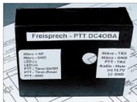
Bild 7: Beschriftetes Gehäuse der Freisprecheinrichtung
