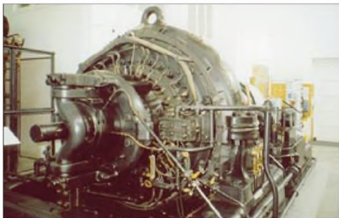
Bild 5: Der Sender im Überblick: links das Hochfrequenzrad, rechts der Elektromotor
