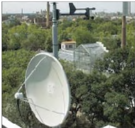
DB0EXP: 60-cm-Spiegel der Linkverbindung zu DB0LPZ und Anemometer der Wetterstation. Foto via http://db0exp.de
