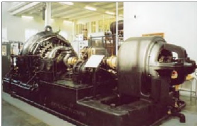
Bild 5: Der Sender im Überblick: links das Hochfrequenzrad, rechts der Elektromotor
