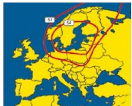
Bild 1: Mit der Allianz mit NSAB sichert sich SES/Astra über das Sirius-Satellitensystem für seine Multimedia- und Internetangebote nicht nur Zugriff zu den skandinavischen, sondern auf Grund der Ausleuchtzonen der Sirius-Satelliten (hier von Sirius 3; Angaben an den Linien: EIRP in dBW) auch zu den wachstumsintensiven baltischen Ländern.
