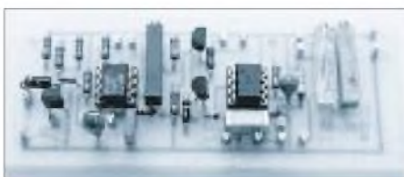
Bild 6: Die fertig bestückte Platine
