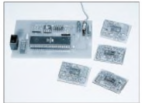
Bild 10: Bei diesem Beispiel wurden die Slaves in SMD realisiert.
