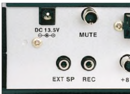
Sogar eine Mute-Buchse ist vorhanden, um den Empfänger bei Verwendung mit einem Sender stummzuschalten. Praxisnah sind getrennte NF-Ausgänge für den Anschluß eines externen Lautsprechers und zur Anfertigung von Mitschnitten.
