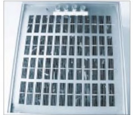
Bild 2: Die Solarzellen wurden in Gruppen zu 12 x 4 Elementen angeordnet.
