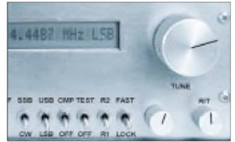
Bild 10: Unten in Bildmitte der Umschalter Fast/Lock , daneben der Drehknopf für die grobe Frequenzvorwahl, rechts unter der Hauptabstimmung der RIT -Knopf
