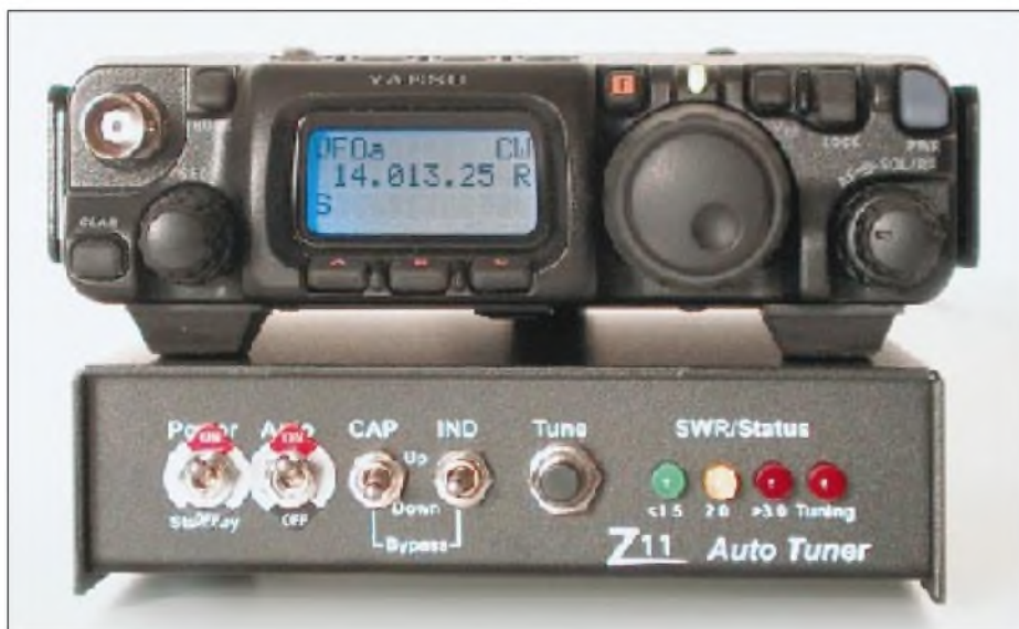
Bild 1: Der fertig aufgebaute Antennentuner Z-11 am FT-817
