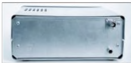
Bild 10: Rückansicht des Basistransceivers, hier mit lose aufgesetzten Halbschalen; hinter der freien Fläche findet ggf. ein Transvertermodul oder eine Endstufe Platz.
