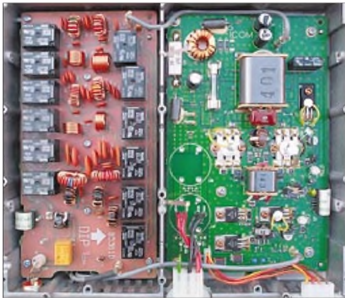
Im oberen Teil des Inneren des Druckguß-chassis sind das Senderstufenmodul und die mit Relais umgeschalteten zugehörigen Tiefpässe angeordnet.
