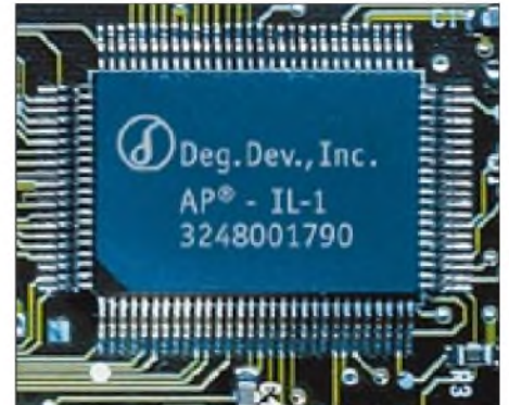
Bild 3: Blick auf den ersten Prototypen der neuen selbstversorgenden IC-Generation
