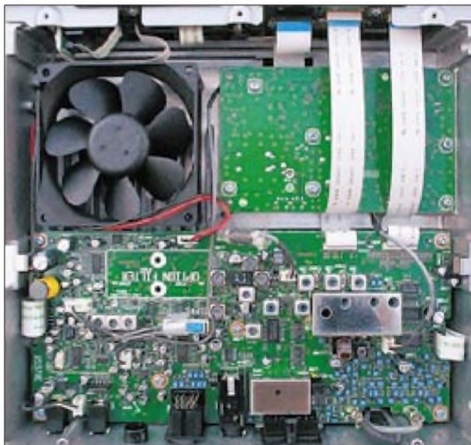
Im oberen Teil des Inneren des Druckguß-chassis sind das Senderstufenmodul und die mit Relais umgeschalteten zugehörigen Tiefpässe angeordnet.
