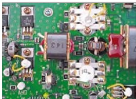
Dioden als Sensoren bei den relevanten Transistoren des Senderendstufenmoduls sorgen über die zugeordnete Elektronik für hohe thermische Stabilität des Senders.
