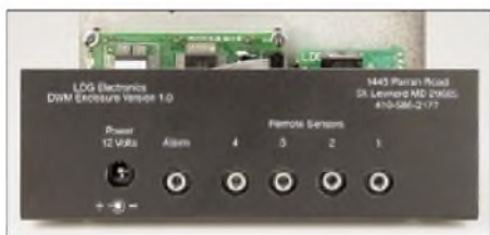
Bild 4: Auf der Rückseite u.a. Buchsen für vier Sensoren
