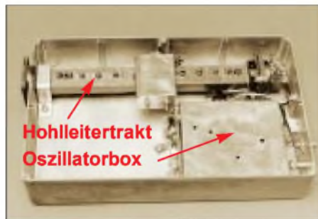
Der damals weit verbreitete G3JVL-Transceiver mit Durchblasemischer. Alle SHF-Baugruppen befinden sich innerhalb des oben im Bild zu erkennenden Hohlleitertraktes.
