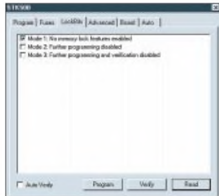
Bild 7: Hier werden die Lockbits eingestellt.
