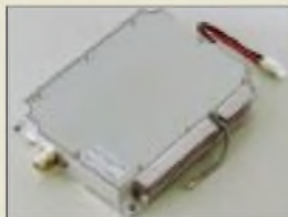
Das 23-cm-Modul UX-910 erweitert den IC-910H zum Tribander.
