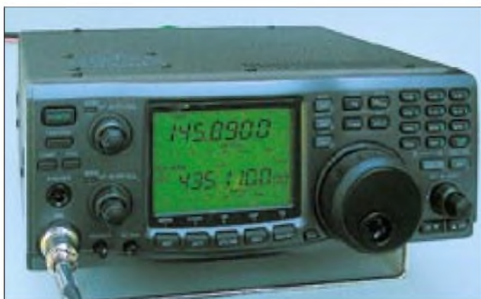
Frontansicht des IC-910H. Neben der Mikrofonaufnahmebuchse sind zwei kleine Achsen zur Einstellung von Mikrofonverstärkung und Sendeleistung zu erkennen.
