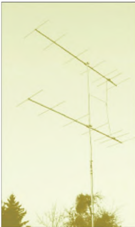
Bild 12: YO vereinfacht auch die rechnerische Nachbildung vertikal gestockter Yagis, deren Eingabe bei nicht speziell für Yagi-Simulation ausgelegten Programmen wie EZNEC 3.0 recht mühsam ist.
