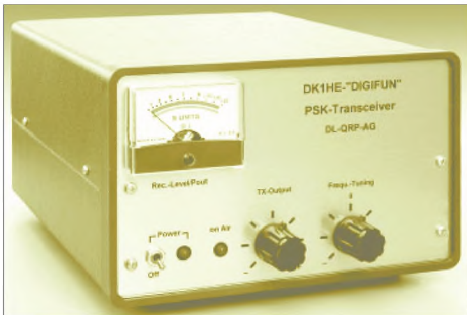
Bild 1: Gesamtansicht eines Mustergerätes des PSK-Transceivers; erstaunlich ist die geringe Zahl notwendiger Bedienelemente. Dabei ist der Drehknopf Frequ.-Tuning sogar noch entbehrlich und stellt lediglich eine Investition in die Zukunft dar.
