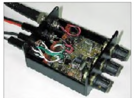
So klein kann QRP sein: der SMK-1 mit 350 mW
