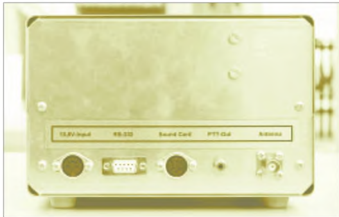
Bild 2: Die Rückseite offenbart v.l.n.r. Stromversorgungs-buchse, PC-Anschlüsse für serielle Schnittstelle bzw. Soundkarte
