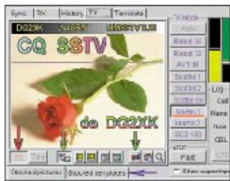
Bild 4: MMSSTV-Sendefenster – ein Bild aus dem TX-Vorschauenfenster erhielt einen Header sowie gut sichtbaren Text für den CQ-Ruf. Die waagerechte Linie im TX-Bild zeigt den Fortgang der Aussendung, der gelbe Balken oben rechts den NF-Sendepegel.
