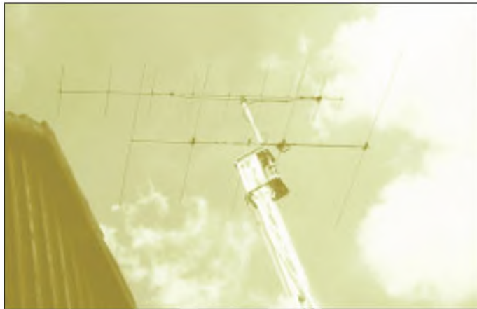
Bild 1: Stationsantenne bei DL7HG, eine 5-Element-Yagi in 13 m Höhe. Darüber befindet sich eine 10-Element-Yagi für 2 m.
