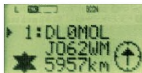
Bild 11: Locator von DL0MOL sowie Entfernung dieser Station – wegen der exemplarisch unterlassenen Eingabe eigener Ortskoordinaten berechnet TH-D7E hier die Entfernung zu JJ00AA (Standardvorgabe).
