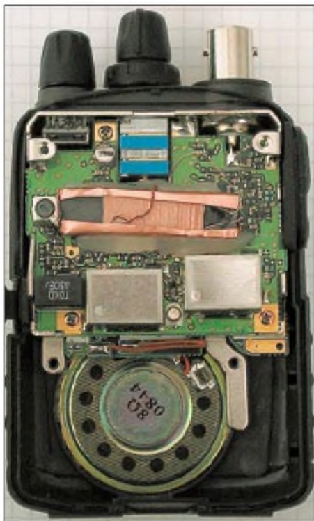
Winzig – und dennoch paßte ein Ferritstab mit hinein.
