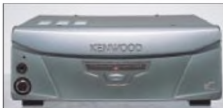
TS-2000 und das fernbedienbare Pendant TS-B2000 mit lediglich einer Power-Taste an der Frontplatte sind ansonsten elektrisch praktisch identisch.
