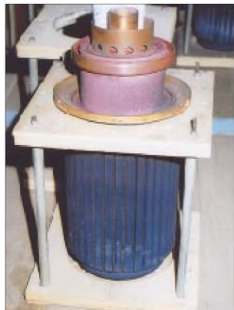
Je 500-kW-Block sind drei Trioden des Typs GU 68 P parallelgeschaltet, das Bild zeigt eine Röhre im Ersatzteillager.
