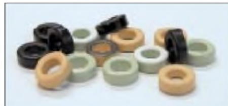
Bild 3: Amidon-Ringkerne zeichnen sich durch eine nutzerfreundliche Farbkennzeichnung aus, die etwas über den Frequenzbereich aussagt. Fotos: Red. FA
