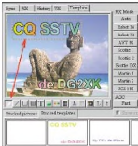
Bild 5: Im Template -Fenster lassen sich Vorlagen herstellen, die aus Text und grafischen Elementen bestehen können, auch die Headergestaltung ist möglich.
