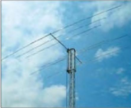
7-Element-Fünfbandbeam von Titanex mit neu entwickeltem Multiresonant-Open-Sleeve-Strahlersystem
