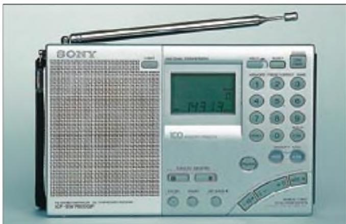
Der ICF-SW7600GR bietet bewährte Technik im neuen Gewand. In seiner Preisklasse ist kein anderer Weltempfänger derart komplett ausgestattet. Die zügige direkte Frequenzeingabe und der Abruf von Speicherinhalten erfolgen über ein numerisches Tastenfeld. Darunter liegen Tasten zur Wahl der Speicherseiten und für den Suchlauf.
