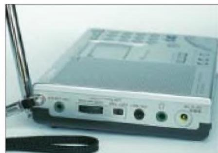
Die Anschlußmöglichkeiten an der linken Gehäuseseite lassen keine Wünsche offen. Der schaltbare Abschwächer läßt sich stufenlos regeln.
