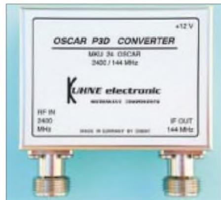
Bild 5: 2,4-GHz-LNB in Innen-Ausführung von DB6NT
