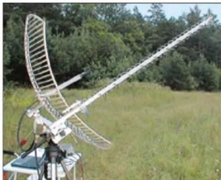
Bild 9: Typische S-Band-Antennen: BBQ-Spiegel und Helix mit 30 Windungen
