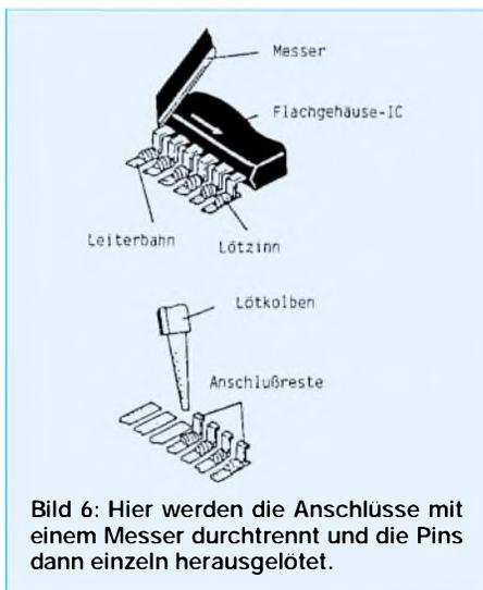
Bild 6: Hier werden die Anschlüsse mit einem Messer durchtrennt und die Pins dann einzeln herausgelötet.
