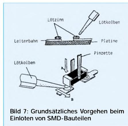
Bild 7: Grundsätzliches Vorgehen beim Einlöten von SMD-Bauteilen
