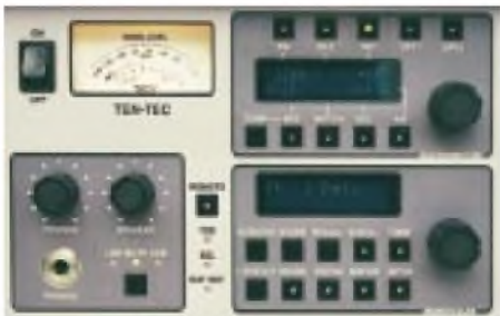
Detail mit „Auxiliary Parameters Group“, Speicher- und Scan-Einstellungen. Hier werden über Menü verschiedene Empfängereigenschaften festgelegt. Fotos: Chr. Ratzer
