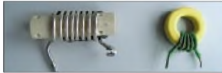
Bild 17: Zwei Spulen annähernd gleicher Induktivität von etwa 1 µH – die Luftspule links, aus 1,5 mm CuAg auf einen Keramikkörper gewickelt, hat bei 17 MHz eine Güte von 175; die rechte, mit CuLW auf einen Amidonkern T68-6 gewickelt, bringt es auf 240 ...
