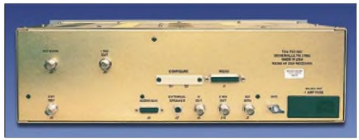
Auf der Rückseite viele Anschlüsse für Zusatzgeräte und PC-Steuerung (o.)
