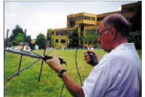
Ray, W2RS, zeigt, wie man mit einfacher Ausrüstung über AO-27 funkt: FT-50, 7- und 3-Ele.-Portabel-Yagis für 70 cm bzw. 2 m
