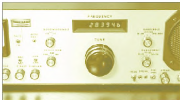
Bild 5: Mustertransceiver des Autors; in der Mitte sind Frequenzanzeige und Feintrieb zu erkennen. Fotos: DC4KU
