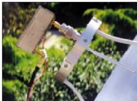
Patch-Erreger mit EVV am 60-cm-Spiegel
