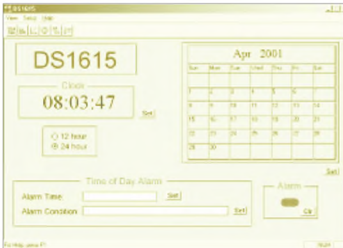
Bild 1: Die Echtzeituhr erfasst Stunden, Minuten und Sekunden; der Kalender Jahr, Monat und Wochentag.
