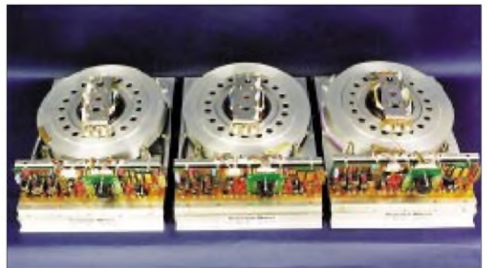
Die drei magnetisch gelagerten Drallräder von AO-40 vor dem Einbau. Foto: W. Gladisch, AMSAT-DL
