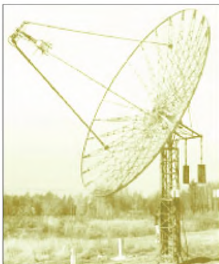
Bild 11: 8-m-Spiegel für 70 cm und 23 cm bei SM2CEW; Peter hat mit dieser Antenne auf 70 cm viele Ein-Yagi-Stationen gearbeitet, die lediglich über 300 bis 400 W verfügten.
