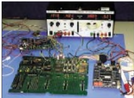
Bordcomputer eines Mini-Satelliten - RAMs nur teilweise bestückt Fotos: DK1KQ
