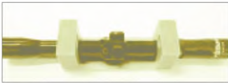
Bild 7: Ein preisgünstiges Zielfernrohr, hier mit Halterung für Laserdiodenmodul
