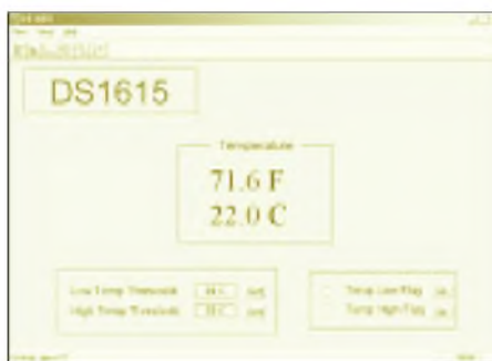
Bild 4: Anzeige der Unter- bzw. Überschreitung eingestellter Grenzwerte
