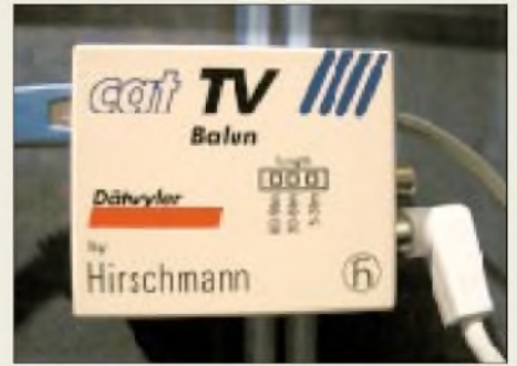
Hirschmann schlägt bei der Multimedia-Gebäudeverkabelung einen neuartigen Weg ein und präferiert statt Koaxialkabel die universelleren geschirmten Doppeladern der Kategorie 6 oder 7. Auf der Teilnehmerseite sorgt dann ein Balun für die Regeneration des BK-Signals. Foto: DL2RD
