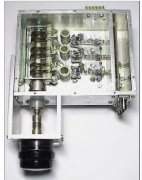
Bild 15: Mechanische Ausführung des beschriebenen VFO 40...70 MHz mit Drehkondensatorabstimmung und DAFC-Anschluß
