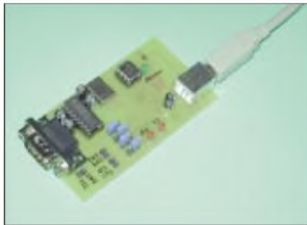
Bild 7: Für Meß- und Testzwecke wurde die Laborversion großzügig aufgebaut und enthält zusätzliche Anschlüsse, um z.B. auch einen Controller anschließen zu können.
