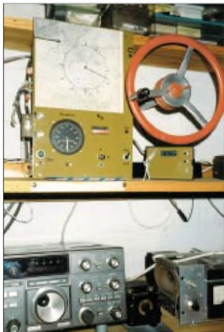
Bild 18: DL2RSX bewirkt die Azimuteinstellung mit einem Handrad – für terrestrischen Funkbetrieb durch nichts zu übertreffen und für den Mond durchaus noch praktikabel.
