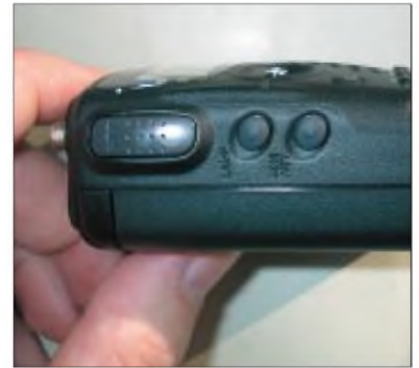
Im Gegensatz zu den darunterliegenden Tasten für Squelchöffnung und Beleuchtung hat die Sendetaste eine griffige Hartschale und einen leichtgängigen Druckpunkt.
