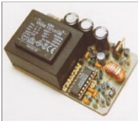
Bild 2: Je nach Trafo läßt sich eine Platine mehr oder weniger kompakt entwickeln.
