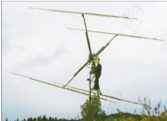
Bild 16: Wahlweise horizontale und vertikale Polarisation mit je viermal 18 Elementen bei Finn, LA8YB, in JO59FR
