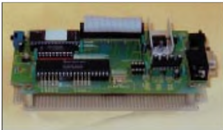
Bild 4: ELV-Prozessorplatine mit den Erweiterungen entsprechend Bild 5
