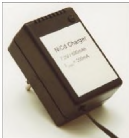
Bild 3: Ansicht des fertigen Ladegerätes im Steckernetzteil-Gehäuse
