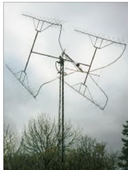
Bild 19: Die in X-Polarisation aufgebaute Antennengruppe von SM5BSZ läßt problemlose, elektronische Umschaltung zwischen verschiedenen Polarisationen zu.
