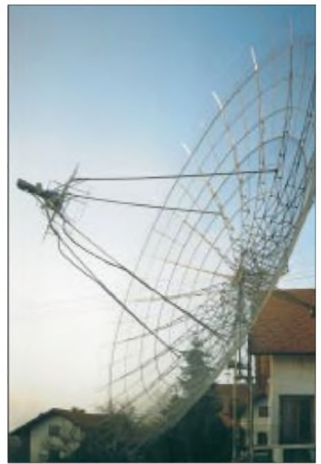
Bild 17: Mit diesem 11-m-Spiegel ist Johannes, OE5JFL, auf 2 m, 70 cm und 23 cm QRV. Polarisationsumschaltung beschränkt sich hier auf den Erreger, vgl. a. [19].
