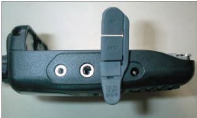
Die Buchsen des TH-F7E für Mikrophon und Ohrhörer bzw. TNC und PC-Programmierung werden je nach Anwendung intern umgeschaltet. Die Stromversorgung und Aufladung erfolgt über eine gängige Hohlstiftbuchse.
