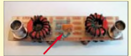
Bild 30: Probeaufbau eines 40-m-Filtern mit Piezofilter (Pfeil) und zwei LC-Kreisen
