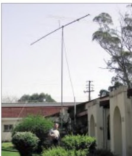
Die 6-El.-Yagi für 50 MHz in KG53NP
