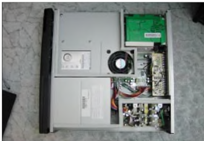
Bild 4: Ein Blick ins Innenleben zeigt (oben rechts) die Anordnung der drei Steckkarten und auch den CPU-Lüfter.
