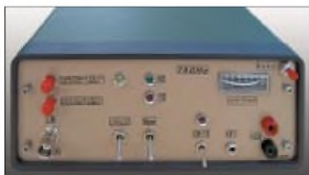
76-GHz-Transverter von DC0DA mit 1,5 mW Output und 12,6 dB Rauschmaß
