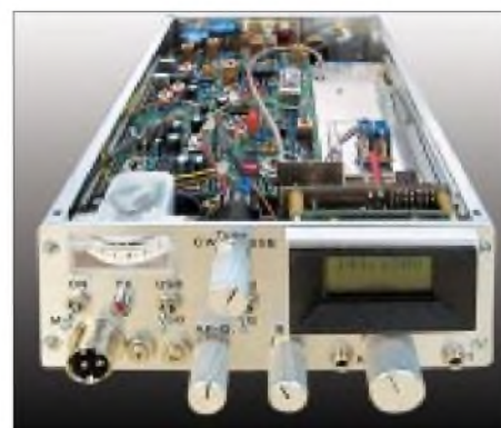
Die Hohentwiel -Modifikation von DF5SL kommt mit Fertigspulen aus, erreicht F = 1,1 dB und verfügt über eine Digitalskala.
