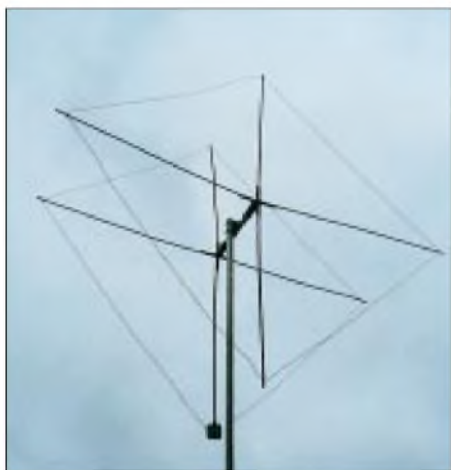
Bild 1: 2-Element-Quad für 6 m, in Diamond-Shape-Form
