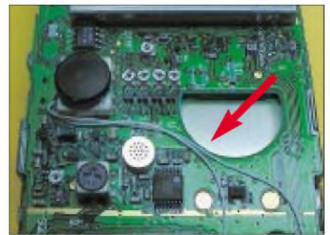
Bild 3: Kabelführung entlang des halbmondförmigen Lautsprecherausschnitts
