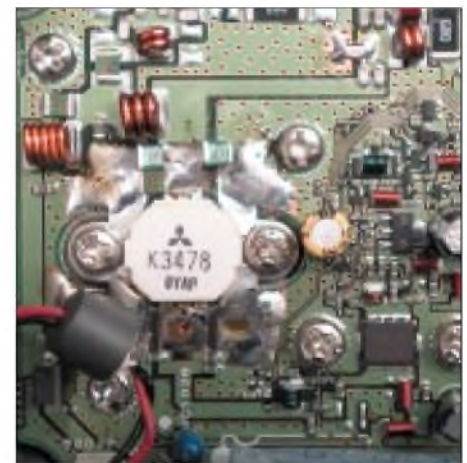
Bild 3: Der Endstufen-MOSFET 2SK3478, der auf 2 m 50 W und auf 70 cm 35 W HF erzeugt. Fotos: Yaesu, DGØZB
