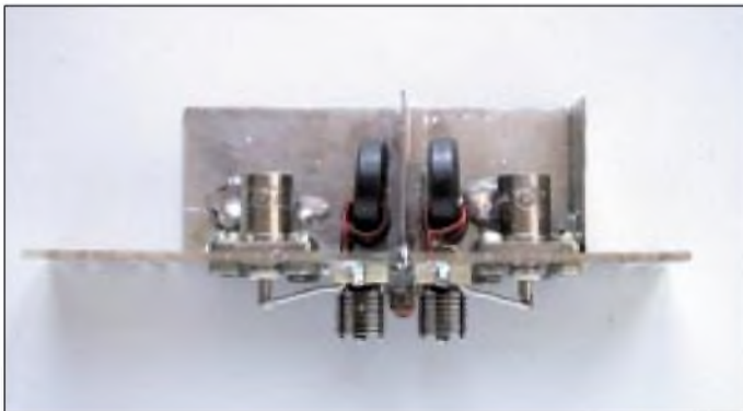
Bild 29: Probeaufbau des Bandpaßfilters für 6 m; die Abschirmwand zwischen den Spulen erwies sich als unumgänglich. Einmal vorhanden, erlaubt sie indes auch einen gedrängteren Aufbau.
