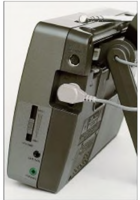
Die rechte Gehäusesseite des KH-WS1 bietet Anschlußmöglichkeiten für Kopfhörer, LINE, Datenkabel sowie Sat-Antenne in gängiger F-Norm. Fotos: hku
