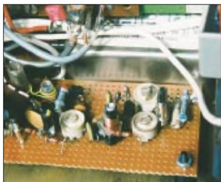
Bild 1: Teilansicht eines 2-m-Konverters – nicht verkaufswürdig, aber zweckmäßig!
