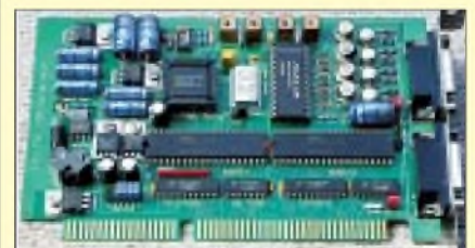
Bild 33: Diese PC-Einsteckkarte für ISA-Bus bildet das Rückgrat des in [15] beschriebenen Wobbelmeßverfahrens.
