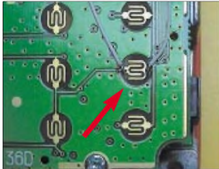
Bild 2: Lötverbindungen an der Call-Taste im Detail
