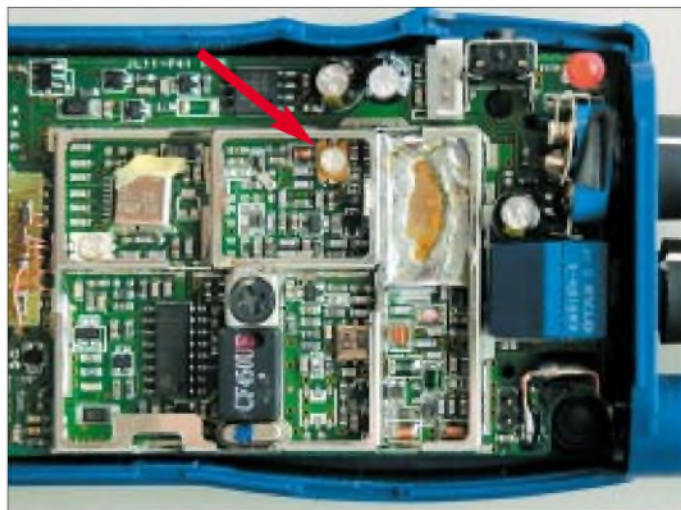
Bild 7: In diesem Detailausschnitt der rechten Platinenhälfte ist das zur Kühlung des Endstufentransistors angebrachte und ringsherum ange-lötete Kupferblech nicht zu übersehen. Der Pfeil weist auf den braunen Trimmer gemäß Text. Fotos: OK2XDX
