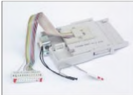
Bild 3: Etwas aufwendiger ist die zweite bei Oppermann erhältliche Ausführung gestaltet. Ein Flachbandkabel dient als „Interface“ zwischen Peripherie und Kontaktierereinheit. Neben den acht Pins zum Chip auf der Karte wird noch ein Schaltkontakt nach außen geführt, der schließt, sobald eine Karte eingeschoben wird.
