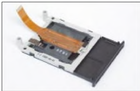
Bild 2: Ohne viel „Schnickschnack“ – die einfache Variante kontaktiert die (genormten) acht Chipkartenanschlüsse und führt sie über eine Filmbahn mit aufgedampften Leiterbahnen nach „draußen“.
