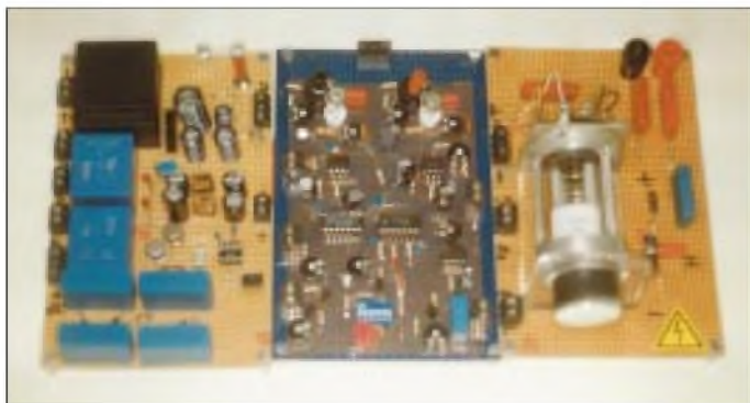
Bild 3: Ansicht der drei Platinen – Spannungs- versorgung, Signalelektronik und Sichtteil
