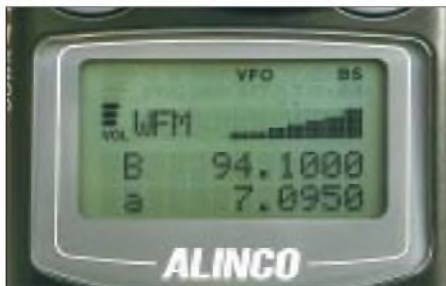
Die Arbeit mit zwei VFO erleichtert die manuelle Frequenzüberwachung. UKW-Hörfunkempfang ist erstmals bei einem Handscanner in Stereo möglich.
