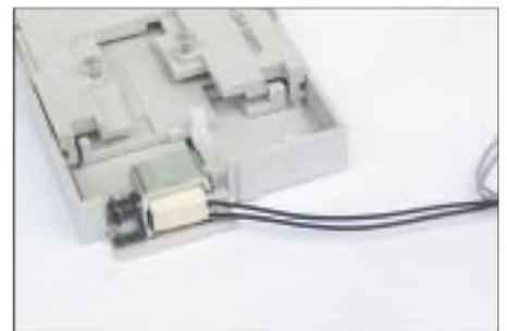
Bild 5: Beim Einschieben der Chipkarte spannt sich eine Mechanik. Der Wiederauswurf der Karte erfolgt elektrisch über die Sperrenfreigabe durch einen Elektromagneten.
