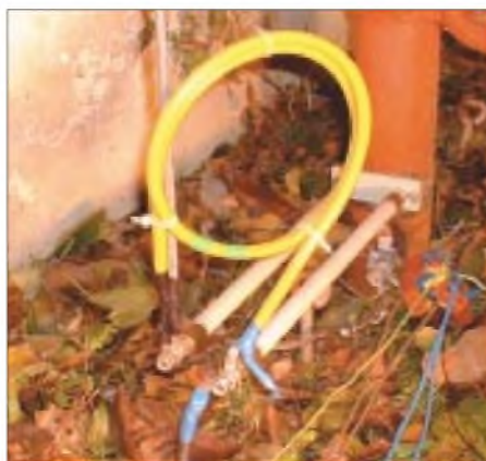
Bild 3: Das Anpaßnetzwerk besteht aus RG-213-Koaxialkabelstücken. Fotos: DM3ML
