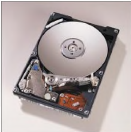
Diese IBM-Festplatte ist bereits mit neuer Technik gefertigt. Die Travelstar 48GH besitzt eine Kapazität von 48 GByte.
