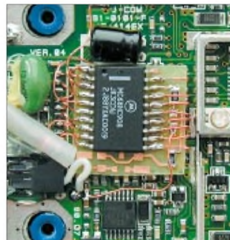
Bild 13: Detailausschnitt der fertig eingebauten Zusatzplatine
