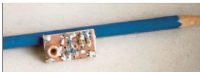
Bild 8: Minitransceiver mit eingebautem ZEM – das zur Anzeige dienende I 2 C-Display ist kaum größer als eine Armbanduhr. Rechts daneben ist der Antennentuner zu sehen.
