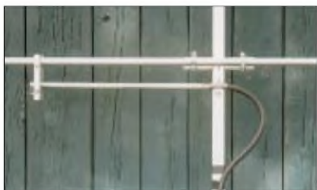
Bild 1: Gamma-Anpassung mittels Aluminiumrohr und Koaxialkabel
