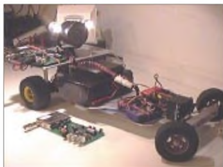
Grundlage für den „fahrbaren ATV-Untersatz“ bildete ein fernsteuerbares Modellauto.
