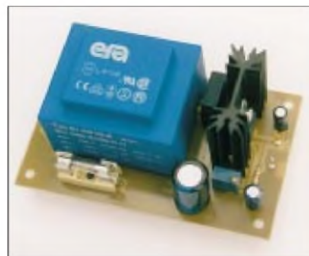
Bild 13: Der Aufbau mit dem Typ LM317 sollte mit einem Kühlkörper auf der Platine durchgeführt werden, um bei maximalem Ausgangsstrom die entstehende Wärme problemlos abführen zu können.
