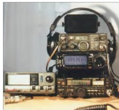
Bild 4: Blick ins Shack bei DG0OPK: Oben FT-790 für den 70-cm-Uplink, darunter der FT-100 für Downlink-Paßbandempfang, ganz unten TR-751 für Telemetrieempfang.
