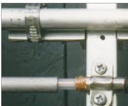
Bild 2: Befestigung des Speisekabels beim HB9QQ-Gammamatch Fotos: DL7HG
