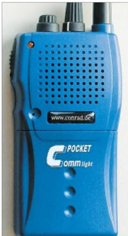
Bild 16: Pocket Comm – umgebaut und wieder betriebsbereit für 70-cm-Amateurfunk
