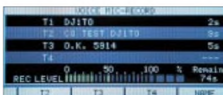
Bild 17: Der Sendesprachspeicher faßt nun sehr flexibel bis zu insgesamt 90 s Standard-Sendepassagen. Man beachte die Restzeitanzeige unten rechts.
