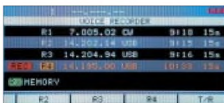
Bild 18: Sein Pendant, der Empfangs-Voice-Recorder nimmt max. 4 \times 15 s beliebiges Empfangssignal, ggf. mit bis zu 30 min „Vorstart“, auf. Speicher 4 ist noch durch eine separate Taste, s. Bild 15, steuerbar. Das blinkende REC, oben rechts im Bild, signalisiert, daß der Recorder (in seinem 30-min-Limit) arbeitet.
