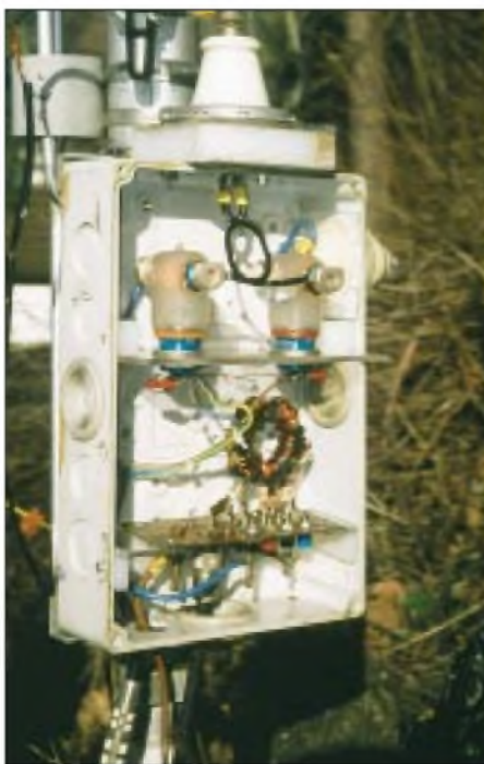
Bild 4: Blick in den Verteilerkasten mit dem Anpaßübertrager, darunter der Isolierfuß, dahinter das vom Isolierfuß verdeckte Standrohr; als Koaxialsteckverbinder nur N-Verbindern verwenden!
