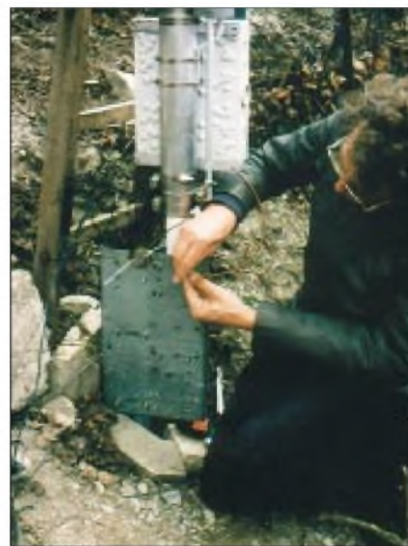
Bild 2: DK8ND am Mastfuß beim Abgleich; vor der umgebauten Boomhalterung aus Zinkblech erkennt man die Koppelspule für das Dipmeter. Die Isolatoren für die Haarnadelschleife bestehen aus PVC-Rohr.
