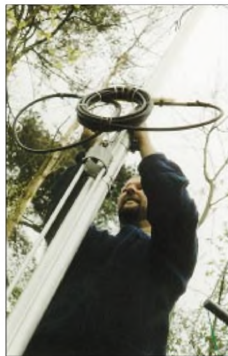
Bild 7: Verlängerungsspule aus Koaxialkabel; zum genaueren Abgleich der Mittenfrequenz ist eine Windung teilweise herausgezogen.
