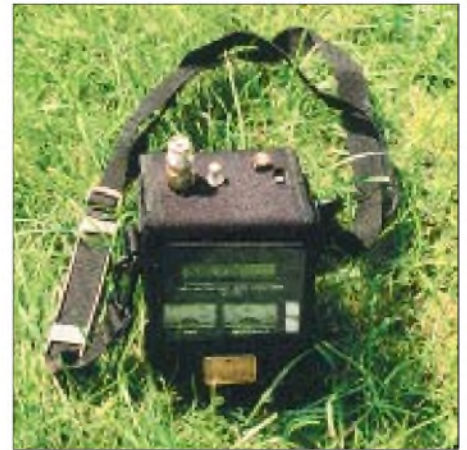
Bild 12: Zur Messung von Real- und Imaginärteil der Antennenimpedanz eignen sich aktive Stehwellenmeßgeräte, wie hier das MFJ-269. Foto: DL2RD
