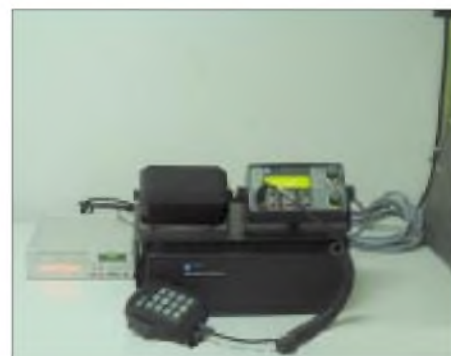
Codan Transceiver mit PTC2 E-Mail via Bushmail. Der Transceiver wird für Voice und Daten genutzt. Fotos: Klaus Renken (4)
