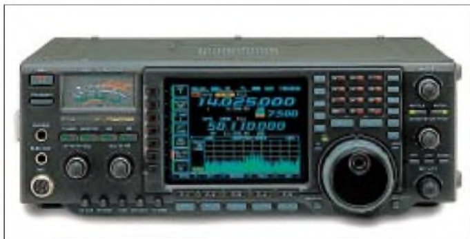
Bild 1: Unterschiede im Äußeren zu seinem Vorgänger IC-756PRO bemerkt man beim IC756PROII außer durch die Display-Darstellungsvariante nur bei genauem Hinsehen.
