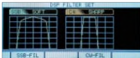
Bild 16: Um das Menü für die Umschaltung der neuen SSB- und CW-Softfilter zu erreichen, braucht es drei Tastendrucke.
