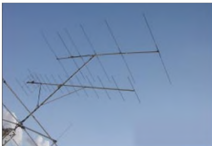
Bild 1: Die eher unaufwendige 13-dBi-6-m-Antenne von SV1DH erbrachte 210 DXCC-Länder auf 6 m (Stand: Januar '02). Bemerkenswert ist tatsächlich, daß Costas im Gegensatz zu PY5CC nicht viel Aluminium spendiert hat. Die geografische Lage in Griechenland macht's...
