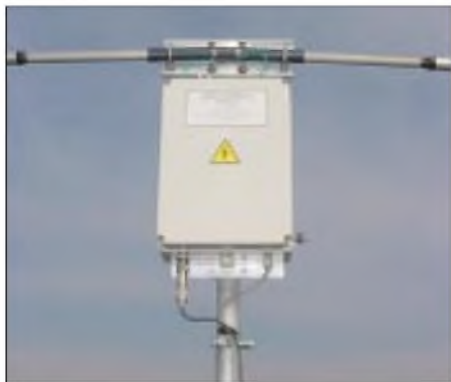
Bild 4: AG-3 im Speisepunkt eines selbstgebauten Drehdipols mit 2 x 6,50 m Länge Fotos: DK7ZB (2), DL2RD (3)
