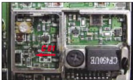
Bild 2: Blick in die VCO-Kammer auf der Platine mit abweichender Leitungsführung
