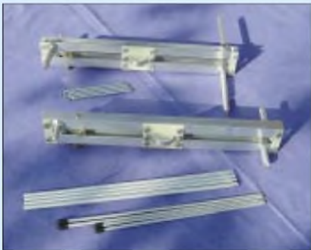
Bild 1: Portabelauführungen der beschriebenen HB9CV-Antenne, oben mit Teleskop-elementen, unten mit dreiteiligen, verschraubten Elementen
