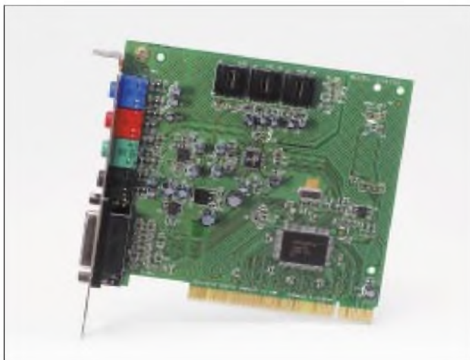
Bild 1: Erst mit einer guten Soundkarte (hier im Bild die Soundblaster 4.1 Digital von Creative Labs) macht der PC so richtig Spaß. Wenn Sie das gute Stück jedoch an externen Verstärkern betreiben, sollten Sie ihm eine Potentialtrennung gönnen. Das vermeidet Brummschleifen und verhindert eventuelle Schäden an der Elektronik.
