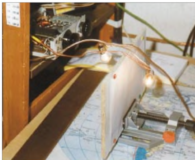
Eine alte, einfache und zugleich sehr hilfreiche Meßeinrichtung wiederentdeckt – das Fettfleck-Powermeter Foto: DL8OL
