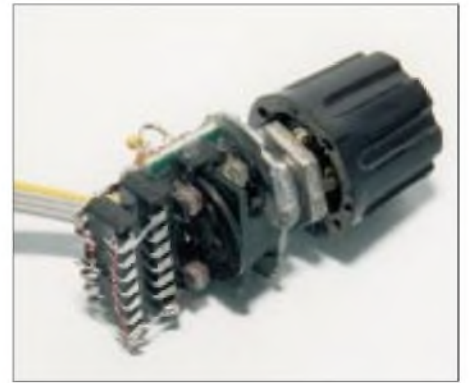
Bild 5: Die Schaltkreise lassen sich auch im „Huckepack-Verfahren“ freiverdrahtet direkt auf der mechanischen Potentiometerkonstruktion mit unterbringen.
