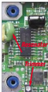
Bild 3: Lage von Resonator und Trimmer für den Modulationshub im Pocket Comm Light
