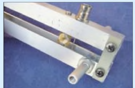
Bild 3: Einspeisung über BNC-Buchse und parallelliegenden Trimmer Fotos: DK4SX
