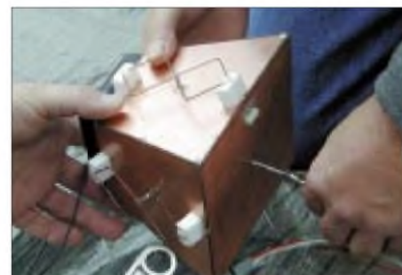
Die Sendeantenne für ATV. Im Inneren ist die S/W-Kamera installiert. Fotos: OE2TZL
