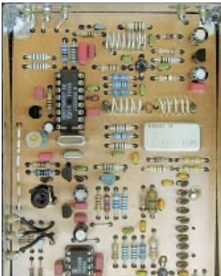
Bild 1: Blick in das geöffnete Weißblechkästchen mit dem HF-Teil des Synthesizers
