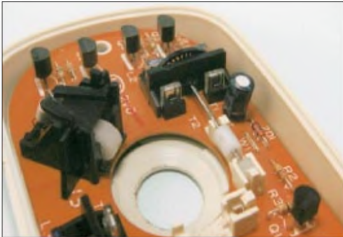
Bild 1: Ein Blick ins Innere der Computermaus bringt schnell Gewißheit darüber, ob sich die x-y-Drehgebermechanik für unsere Zwecke einsetzen läßt.
