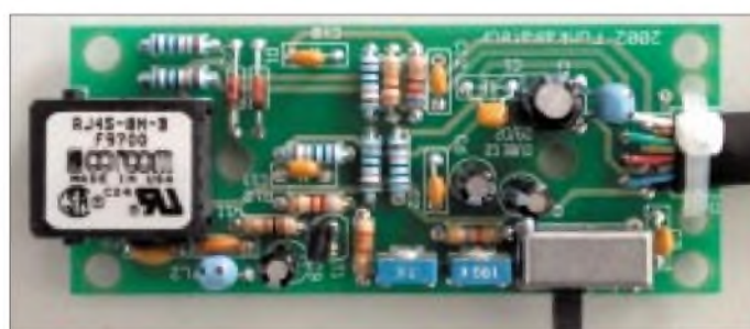
Bild 1: Schaltbild (o.) Bild 2: vollständig bestückte Platine (r.) Bild 3: SSM2165, das Herzstück in SMD-Ausführung (u.)
