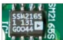
Bild 1: Schaltbild (o.) Bild 2: vollständig bestückte Platine (r.) Bild 3: SSM2165, das Herzstück in SMD-Ausführung (u.)
