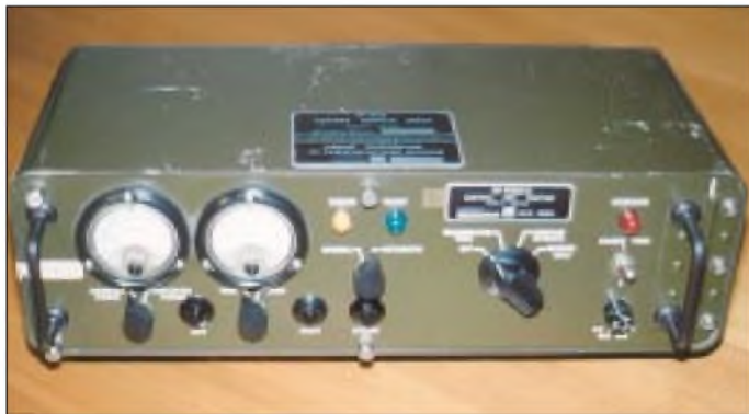
Bild 1: Die Frontseite des Bedienteils – im „Military Look“. Die Lämpchen an der Frontplatte geben Auskunft über den Status des Tuners.
