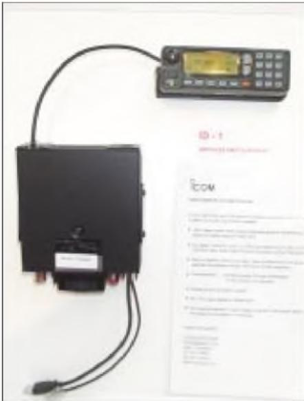
Mit dem „D-STAR“-System führt Icom die nächste Generation digitaler Amateurfunksysteme ein. Der neuentwickelte Digitaltransceiver ID-1 diente in ersten Experimenten als Terminalschnittstelle. Foto: DD6AE
