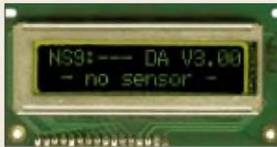
Das Modul beinhaltet einen integrierten ASCII-Zeichengenerator und ist in Baugröße und Interface kompatibel zu bekannten LCD-Modulen.
