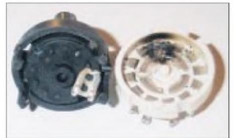
**Bild 5: Infolge unzureichender Spannungsfestigkeit zerstörter Stufenschalter**
