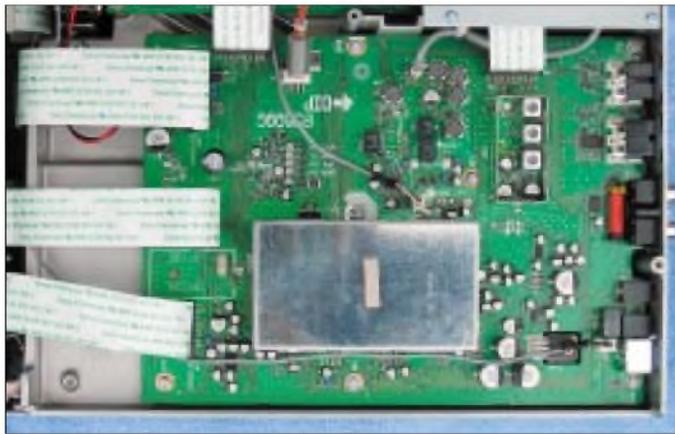
Die Empfängerleiterplatte ist durch die Umstellung auf DSP-Selektion u.a. kleiner geworden.
