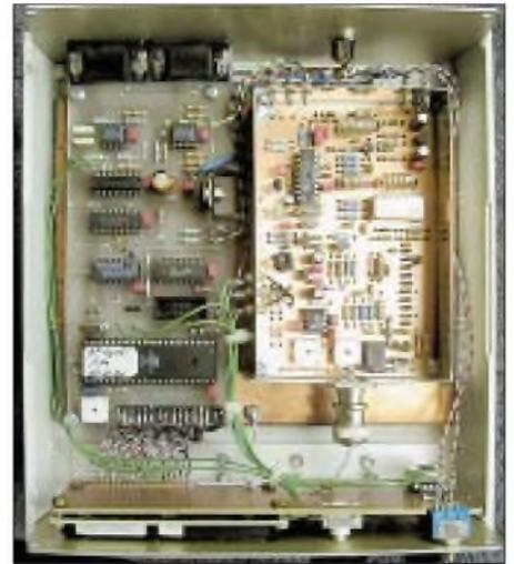
Bild 6: Musteraufbau des Synthesizers mit HF-Teil (rechts) und Steuerungseinheit
