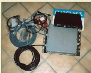
Kommt mit allen erforderlichen Kabeln daher: Yaesu-Antennentuner FC-1000 Foto: DL4EEC
