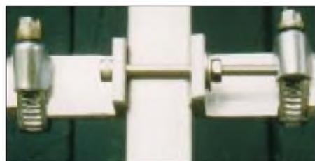
**Bild 3:** Schlauchschellen als Elementhalter, Ansicht von unten
