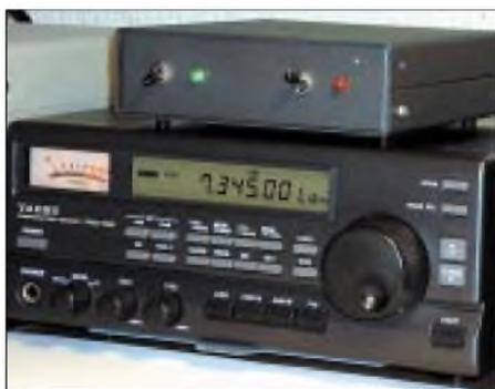
Bild 1: Fertig aufgebauter Synchrodetektor auf dem FRG-100
