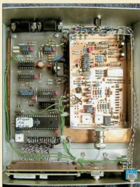
Der HF-Synthesizer wird durch die links im Bild zu erkennende Steuerungseinheit zu einem eigenständig arbeitenden Gerät. Foto: DH1AAD
