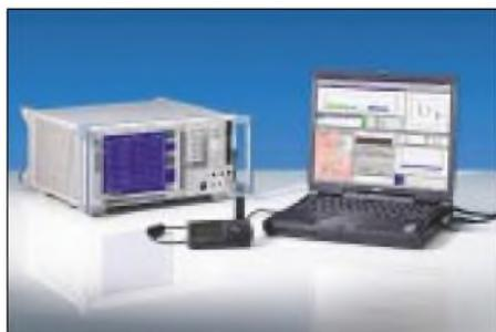
**Der „UMTS PN-Scanner“ ist ein Meßsystem für die Unterstützung der UMTS-Netzplanung.**
