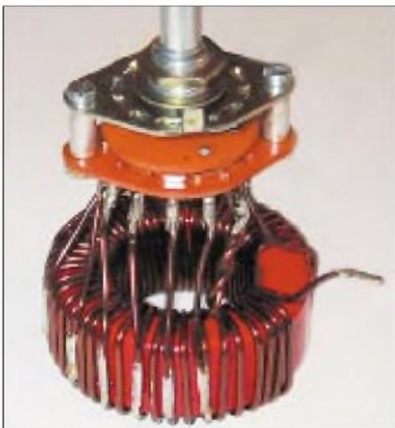
**Bild 4: Stufenschalter und Schwingkreisspule fertig verdrahtet – die Koppelschleife fädelt man erst im eingebauten Zustand durch. Die zweite Schalterebene wurde entfernt.**
