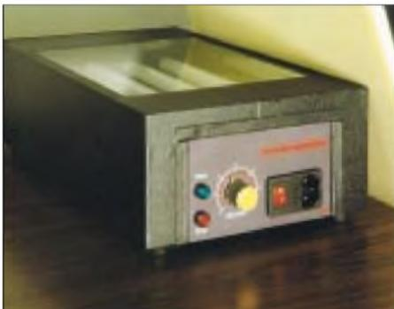
Bild 1: Ansicht des fertig aufgebauten Eigenbau-Belichtungsgerätes für Leiterplattenlayouts
