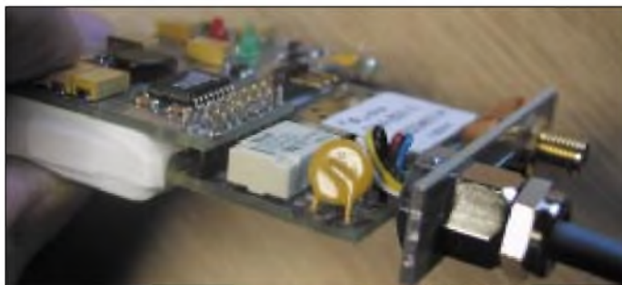
Bild 4: Doppelstöckiger Aufbau der GPS-RX Platinen
