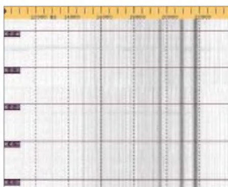
Bild 11: Signale von ALPHA; das 14,881-kHz-Signal ist leider vom eigenen PC gestört.
