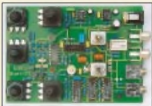
Der 80-/40-m-QRP-Sender enthält fast keine Spulen und ist daher leicht nachzubauen. Foto: DJ8IL
