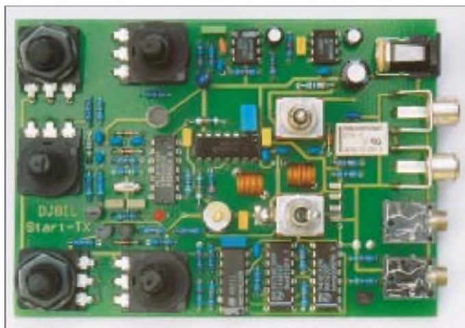
Bild 2: Betriebsfertig bestückte Platine; die Anordnung der Bauteile läßt dieselbe Gliederung erkennen wie im Stromlaufplan.
