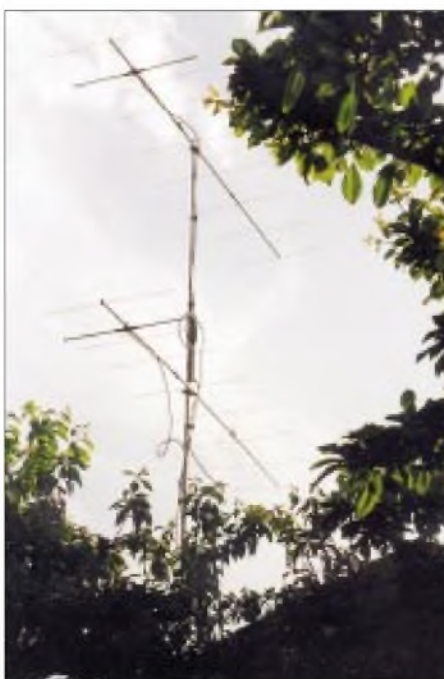
Die 2 x 9-Elemente-Yagis übereinander gestockt, bewährt in etlichen vorangegangenen Einsätzen.
