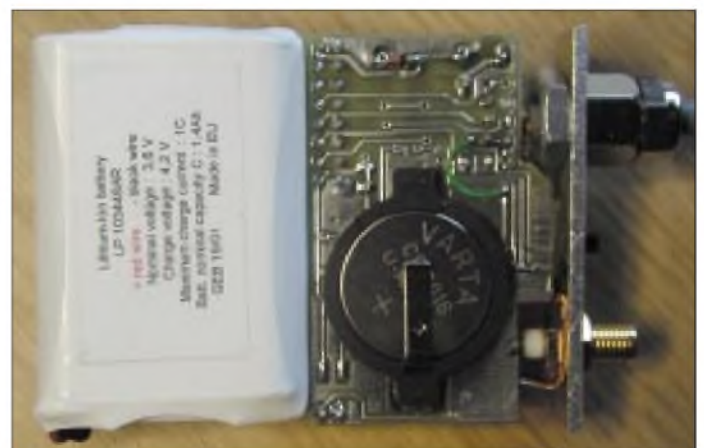
Bild 4: Doppelstöckiger Aufbau der GPS-RX Platinen
