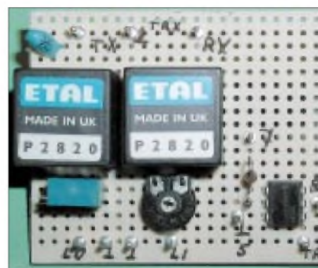
Bild 5: Die wenigen Bauelemente für das Soundkarteninterface sind auf einer Lochrasterplatine schnell untergebracht.
