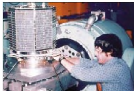
Projektleiter Jan King, W3GEY, montiert AO-7 für den Vibrationstest. Foto: AMSAT-NA
