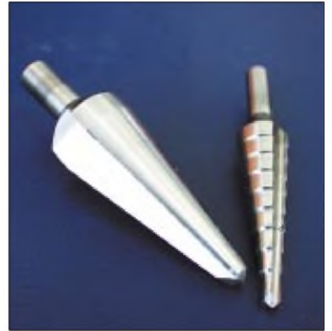
Bild 7: Schälbohrer zum Herstellen von sauberen Löchern in Dünnsblechen
