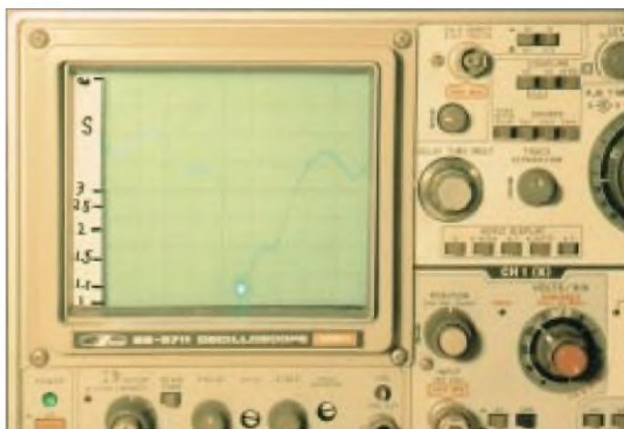
Bild 2 : Verlauf des Stehwellenverhältnisses in Abhängigkeit von der Frequenz. Abszisse: etwa 3 MHz/ Skalenteil Ordinate: s von 1 bis \infty
