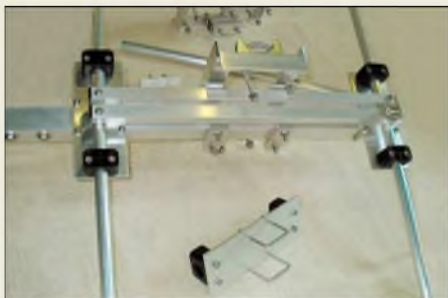
Die Beams von Optibeam zeichnen sich durch ein neuartiges Speisesystem aus, das Mehrbandspeisung mit einem gemeinsamen Koaxialkabel ermöglicht.
