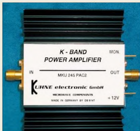
Diese 1,5-W-PA für 24 GHz kommt von Kuhne elektronik; der Verstärkerchip wird bei der Fertigung durch Bonddrähte mit der Platine verbunden.
