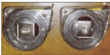
Bild 2: Die Rückseite der Maßbänder mit bereits verlöteten Winkeln
