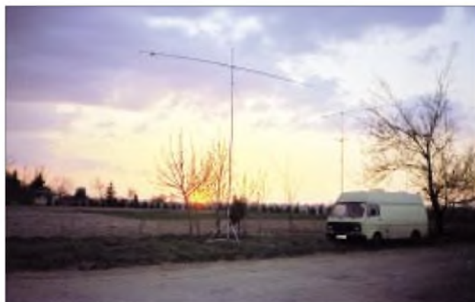
Die aufgebaute Station in KN49KA mit Sonnenuntergang in Richtung Deutschland; links die 17B2 für 2 m, rechts die 9-Element-Yagi für 2 m sowie die HB9CV für 6 m.
