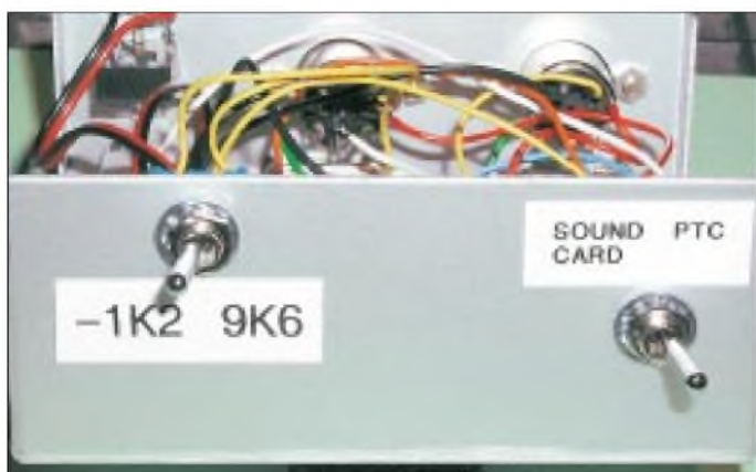
Bild 3: Frontseite der Umschaltbox von DH1NHM mit den zwei Kippschaltern
