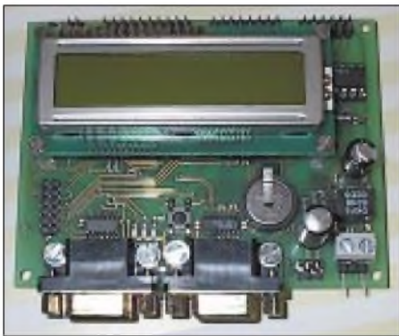
Bild 1: Fast vollständig in SMT aufgebaut: das MCS ® 51-basierte Mikrocontroller-Board µAnt51
