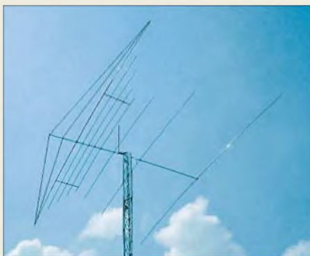
Alle Bänder von 40 bis 6 m vereint der 6 m lange TS8 von Titanex; Speisung erfolgt über eine symmetrische Zweidrahtleitung
