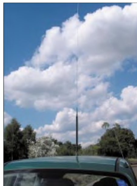
80-m-Antenne HFC-80L auf dem Dach eines Pkw. Deutlich sind Fußpunktspule mit Stabaufnahme sowie die Hülse zur Aufnahme des oberen Stabteils zu erkennen.
