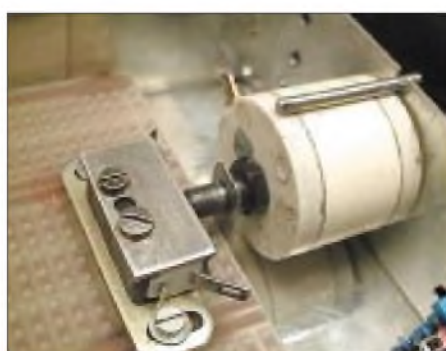
Bild 13: „Mikro-Pot“ – eine Kombination von Mehrgangpotentiometer und Mikrotaster. Das Potentiometer muß dazu ein gewisses Axialspiel aufweisen. Fotos: OK1DPX
