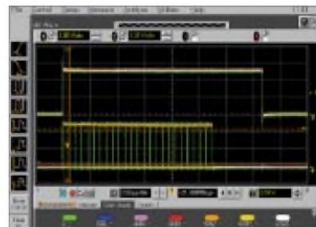
Bild 5: Ausgangssignal des DSP AL3101 (Eingang des DAC), jedoch ohne AGC, Empfänger voll aufgeregelt
