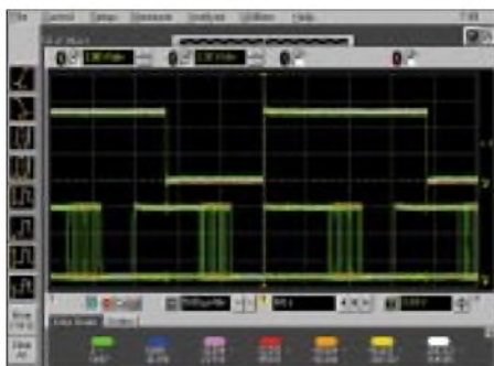
Bild 1: Systemtakt (WDCLK) und Ausgangssignal des Analog/Digital-Konverters AL1101 bei offenem Eingang (ohne Signal)
