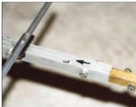
Verschraubung der Tragrohrhälften mittels zweier Messingstreifen
