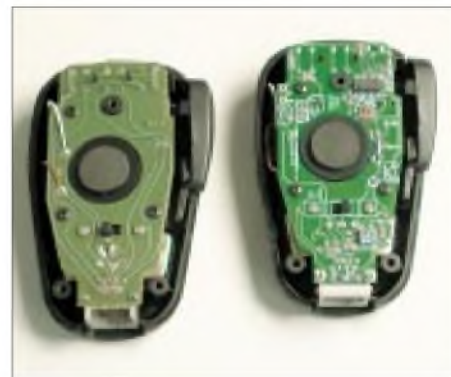
Bild 4: Innenansicht des Original-Yaesu-Mikrofons MH-31A8J (l.) und eines umgebauten Mikrofons (r.)
