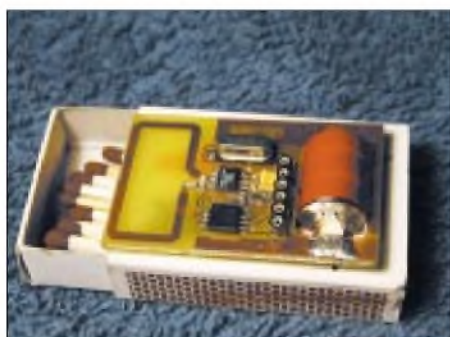
Bild 2: Durch seinen kleinen, kompakten Aufbau paßt das Gerät sogar in eine Streichholzschachtel.
