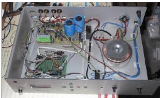
Bild 12: μAnt51 im Einsatz: Steuerung eines Eigenbau-UKW-FM-Tuners
