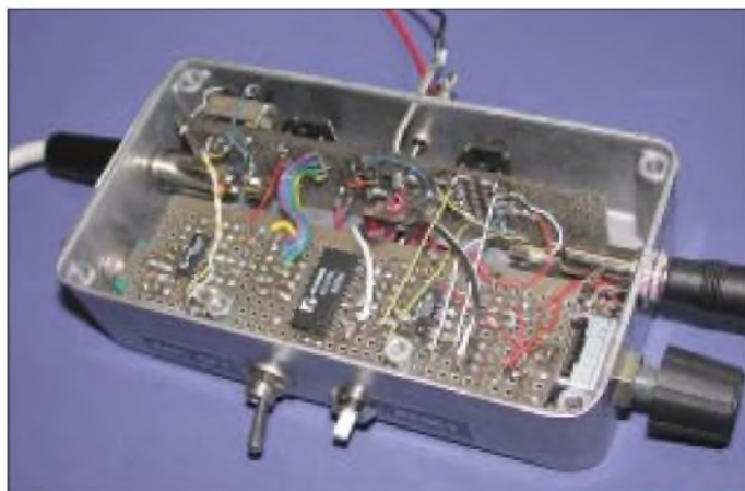
Bild 2: Experimentalaufbau des DSP-RX-Moduls mit zwei schaltbaren Filtern, abschaltbarer AGC und Paßband-Tuning
