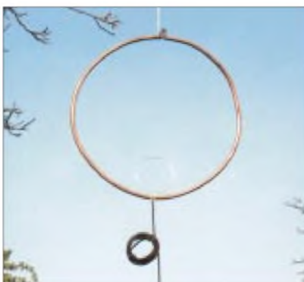
Bild 1: Magnetische Antenne für 6 m, zum Fotografieren vertikal aufgehängt. Man erkennt auch den in der vorigen Ausgabe erwähnten Koaxialkabel-Balun.
