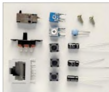
Bild 3: Außer der SMD-bestückten Platine enthält der Umbausatz noch diese Teile, die mit einem kleinen Lötcolben selbst bestückt werden müssen.
