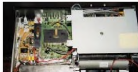
Bild 3: Das umgeklappte PA-Modul mit Sicht auf die RF-Platine (die grüne Platine in der Mitte)
