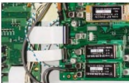
Bild 6: Gelöste Flachbandkabel an der IF-Platine Fotos: DL8LBK
