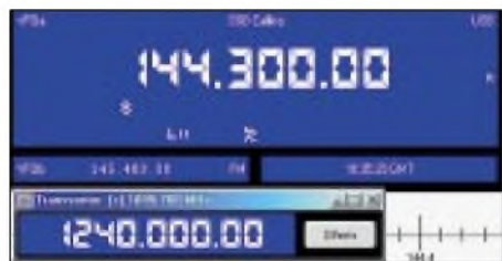
Bild 4: Das Transverter-Display stellt die tatsächliche Arbeitsfrequenz dar.
