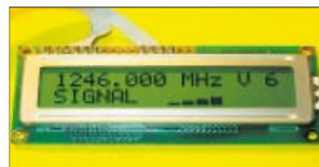
Bild 4: Displayanzeige im Monobandbetrieb; erste Zeile: Frequenz, VFO-Betrieb, Speicher 6; zweite Zeile: Empfangsfeldstärke
