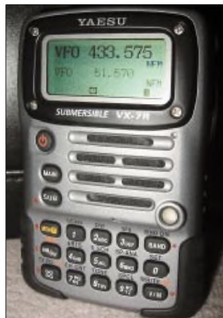
Bild 2: Eindeutige Zuordnung der Gerätefunktionen durch unterschiedliche Farben – die Wirkung der Strobe-Lampe ist auf dem Foto nicht darstellbar.
