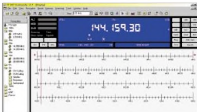
Bild 2: FT-817 Commander mit Frequenzdisplay, analoger Frequenzskala und vielen anderen Optionen
