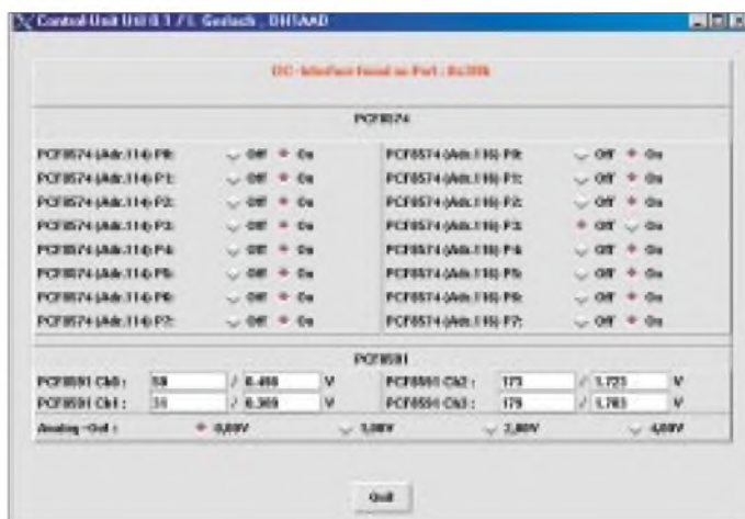
Bild 6: Dieser Screenshot der Software Control-Unit Util 0.1 vermittelt einen Überblick zu den Steuerungsmöglichkeiten. Foto und Screenshot: DH1AAD
