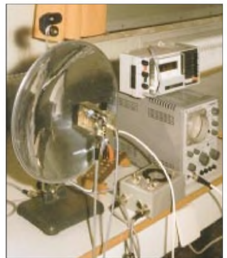
Bild 2: Versuchsanordnung eines Infrarot-Ortungsgeräts (Flammenmelder)
