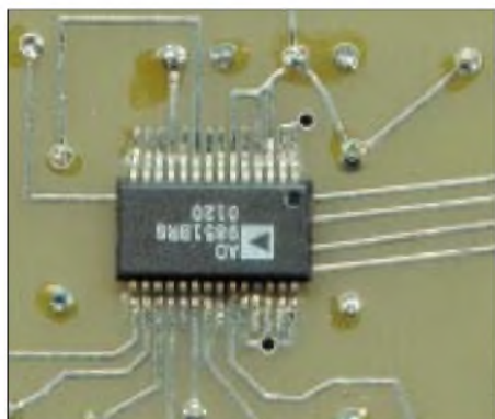
Bild 9: Auf die richtige Lage des AD9851 ist beim Einlöten besonders zu achten.
