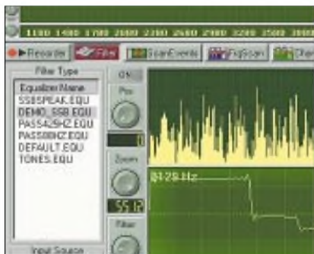
Bild 8: Einmal gemachte Filtereinstellungen können komfortabel als Equalizer-Dateien gespeichert und wieder abgerufen werden. Der Filterverlauf läßt sich im unteren Feld einfach mit der Maus vorgeben.
