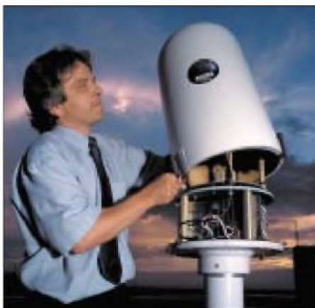
Bild 12: Wartung eines Impact-Sensor (Gewitterpeilantenne) des Blitz-Informations-Dienstes von Siemens Werkfoto
