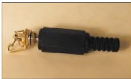
Bild 4: Die Kontakte an der Buchse dienen gleich mit zum Ein- und Ausschalten des Fuchsjagdeempfängers.
