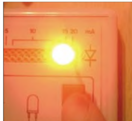
Bild 2: Rote LEDs mit 10 000 mcd lassen sich kaum richtig fotografieren: Der Kamerasensor wird übersteuert.
