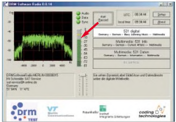
Bild 13: Softwaredecoder von Fraunhofer [5] im eingerasteten Zustand; aus den Lautsprechern ertönt dabei ein lupenreiner Stereosound. Screenshots: DL3KS
