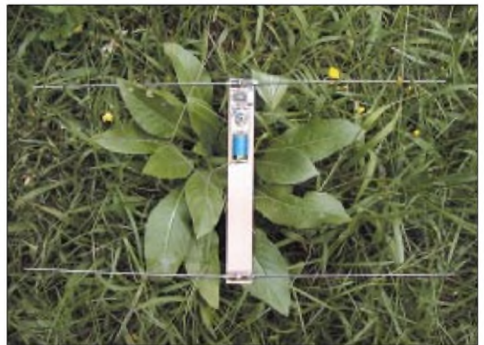
Bild 7: Gesamtansicht des Empfängers, hier als Laboraufbau, bei dem die Platine als Antennenträger dient Fotos: DL1UNO
