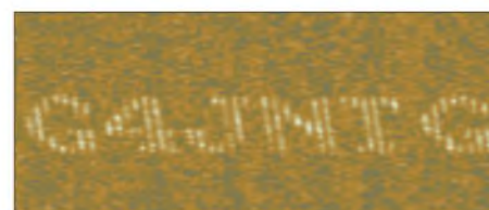
Typisches Bild einer Multiton-Hellschreiberaussendung mit einer Bandbreite von nur 10 Hz
