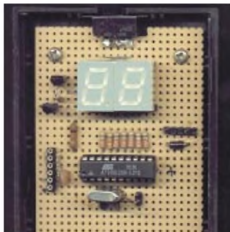
Bild 4: Die erste Aufbauvariante erfolgte testhalber auf Lochrasterplatine.
