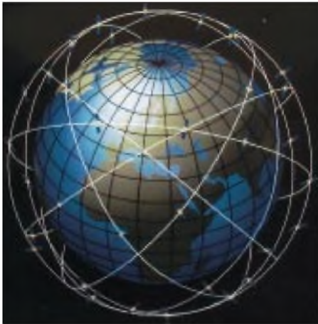
Bild 1: Schalenförmig um die Erde legen sich bei LEO- und MEO-Mobilfunksatellitensystemen ganze Satellitenschwärme.
