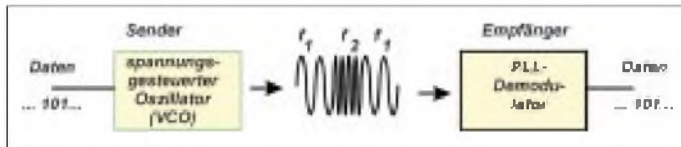
Bild 3: Für Amateur- und Lehrzwecke eignet sich auch die Frequenzumtastung als Übertragungsverfahren.
