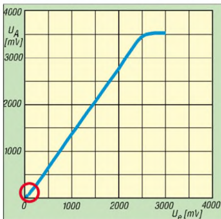
Bild 4: Angezeigte Gleichspannung in Abhängigkeit von der HF-Eingangsspannung; zwischen 100 und 2000 mV Eingangsspannung; hier der untere Teil des Messbereichs ist die Anzeige annähernd linear.
