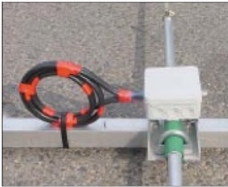
Bild 8: Fertig montiertes Mittelstück in der Antenne
