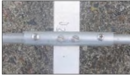
Bild 9: Befestigung der Parasitärelemente bei einem Vierkantboom
