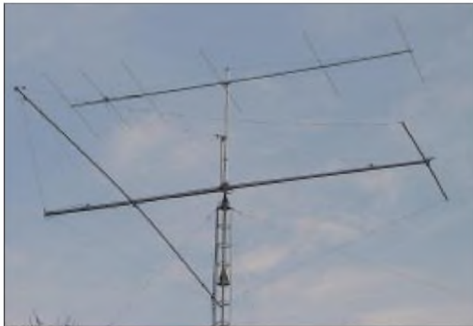
Bild 1: Die 7,20 m lange 6-Element-Yagi über der Kurzwellen-Logperiodic DLP-15
