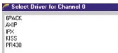
Bild 5: Auswahl des PR430-Treibers im FlexNet Control Center
