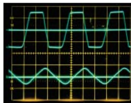
Bild 16: Oszillogramm des Multivibrators bei 150\text{ kHz} : Die Impulsflanken benötigen eine Zeit von über 1\ \mu\text{s} . C = 1\text{ nF} , R = 10\text{ k}\Omega , R_2 = 6,8\text{ k}\Omega , R_m = 100\text{ k}\Omega . Der untere Kurvenzug zeigt U_e ; y = 2\text{ V/skt} , x = 2\ \mu\text{s/skt} . Der obere Kurvenzug zeigt U_a ; y = 5\text{ V/skt} , x = 2\ \mu\text{s/skt} .
