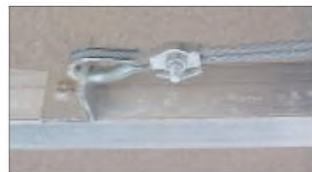
Bild 25: Stahlseil mit Kausche und Kastenklammer zur Abspannung des Booms
