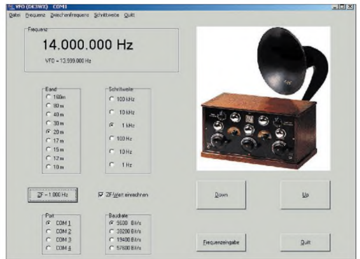
Bild 2: Das vom Autor erstellte Programm Scfradio ist speziell für den Einsatz des NWT als Hauptoszillator eines Direktmischempfängers zugeschnitten. Screenshot: DK3WX
