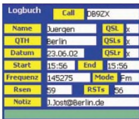
Bild 10: Selbstredend ist im WinCE-Commander ein Logbuch enthalten; die Frequenz kommt via Remote-Control ins Log.
