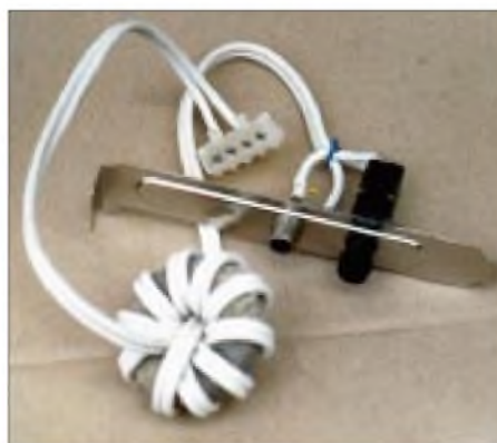
Slotblech und Entkopplung vor dem Vergießen mit der Heißklebepistole
