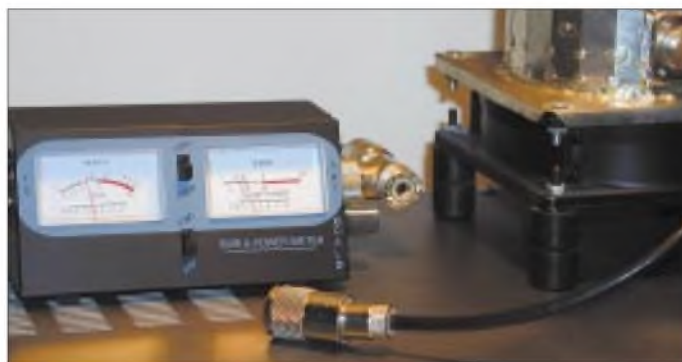
Bild 5: Messungen an einer 80-m-Antenne mit langer Zuleitung bei DK6AE mit handelsüblichem SWV-Messgerät und Dummyload Fotos: DK6AE
