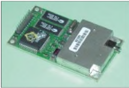
Bild 4: Eine zweiseitige SMD-Bestückung ermöglicht eine geringe Baugröße.
