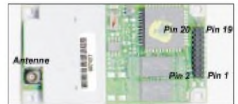
Bild 6: In diesem Foto finden wir neben der Zählweise des Steckverbinders auch den Anschluss der Antenne.
