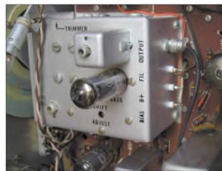
Bild 2: VFO des HW101. Hier ist die C-Diode für die DAFC nachzurüsten. Fotos: DL8WA
