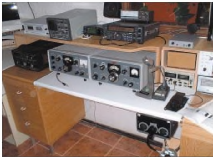
Bild 1: Collins-Line bei EA8AZC, links Sender, rechts Empfänger. Links neben dem Sender steht noch ein uralter Drentron Linear-Verstärker, der jedoch nicht angeschlossen ist.
