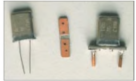
Bild 4: Ein kleines Stück Leiterplattenmaterial und zwei Drahtstifte bilden einen Adapter für HC 18/U-Quarze.
