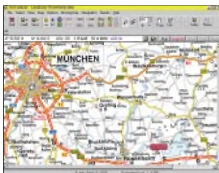
Bild 5: Programm OziExplorer mit individueller Landkarte und dem rot eingezeichneten Wegpunkt „JN67DU“. Die Symbolleiste bietet die üblichen Buttons, wie z.B. Zoom, Datei laden, speichern, öffnen sowie Wegpunkte setzen und löschen etc.
