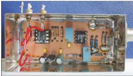
Bild 1: Musteraufbau des niederohmigen HF-Messaufnehmers Foto: DH1AAD
