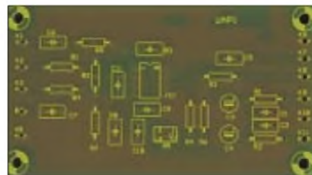
Bild 2: Jede der Platinen trägt einen individuellen Bestückungsaufdruck, hier gezeigt am Beispiel der Platine UAP1.
