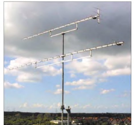
Bild 3: 20-Element-Yagi mit Vierfachreflektor und 23-Element-Yagi im Vergleich
