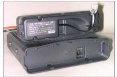
Mit abgesetzt betreibbarem Bedienteil und am Bedienteil selbst anschließbarem Mikrofon bieten sich vielfältige Montagemöglichkeiten.
