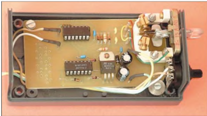
Bild 1: Fertig aufgebaute Morsetaste; rechts im Bild die aus einem Telegrafengerät bestehende Gebemechanik Foto: DL7UWE
