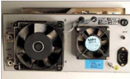
Bild 4: Rückseite mit Lüftern – der linke kühlt die Röhre und der rechte den Netztrafo.
