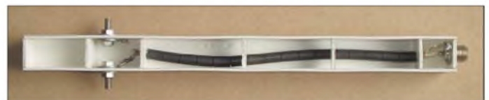
Bild 5: Die Mantelwellensperre findet in einem U-Profil Platz
