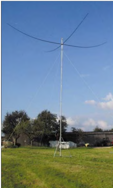
Bild 1: Spiderbeam auf einem 10-m-Aluminium-Schiebemast – dieser kleine Teleskopmast und ein Fernsehtrotor sind vollkommen ausreichend. Fotos: DF4SA
