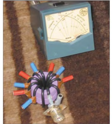
Bild 4: Spartransformator zur Antennenanpassung
