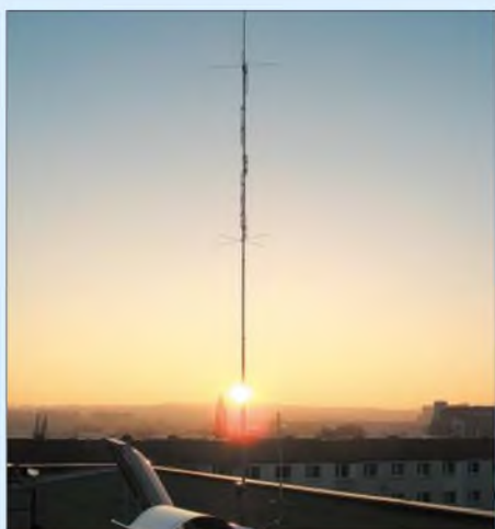
Bild 2: Diese Vertikalantenne leistet hier auf dem Nordhang von Dresden einen weitaus besseren Job, als stünde sie in der Innenstadt im Elbtal. Foto: DK4PL
