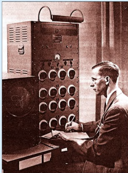
Bild 1: Der „Antennalyzer“, ein röhrenbestückter Analogrechner zur Simulation des elektromagnetischen Feldes um eine Antenne Foto aus [1]
