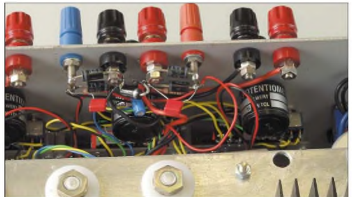
Bild 10: Zwischen Platine und Klemmanschlüssen werden einige Bauelemente frei verdrahtet.
