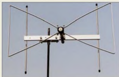
70-cm-Butterfly-Antenne, hier für vertikale Polarisation montiert.
