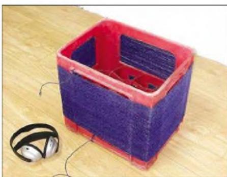
Auch eine praktische Idee: die Getränkekiste als Spulenkörper.
