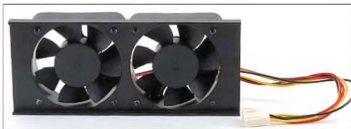
Schwer verzichtbares Zubehör bei der Nutzung mit lang dauernem Oberstrichbetrieb wie SSTV, RTTY oder FM: der auf den Kühlkörper aufschraubbare Doppellüfter, Modell 308. Der Stecker ist innen im Gerät aufzustecken.
