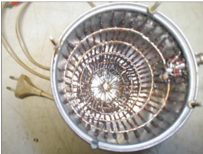
Bild 4: Blick in die geöffnete Kaffeedose auf den Widerstandskegel; deutlich sind die Kupferringe der einzelnen Widerstandsebenen zu erkennen.
