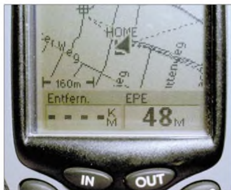
Bild 5: Schlechter Empfang äußert sich durch die Anzeige eines hohen EPE-Werts (EPE = Estimated Position Error). Bei einem Positionsfehler von 48 m ist die Cache-Suche hoffnungslos.
