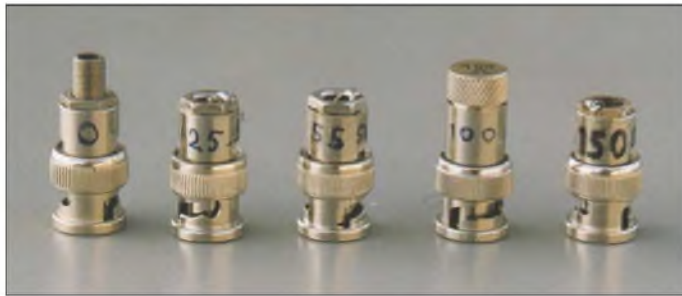
Bild 7: Abschlusswiderstände zum Kalibrieren der SWW-Anzeige
