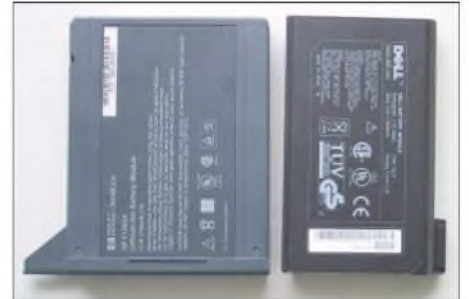
Bild 2: Verschiedene Notebookakkumulatoren: Der große Akku ist ein Backup-Akkumulator mit 2,7 Ah, der kleinere ein neueres Modell mit 3,8 Ah Kapazität
