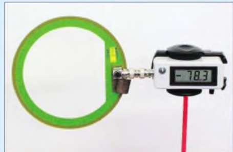
Bild 2: Aus der im Fernfeld einer Antenne mit einer H-Feldsonde gemessenen magnetischen Feldstärke lässt sich die elektrische Feldkomponente berechnen, siehe Kasten 3. Werkfoto
