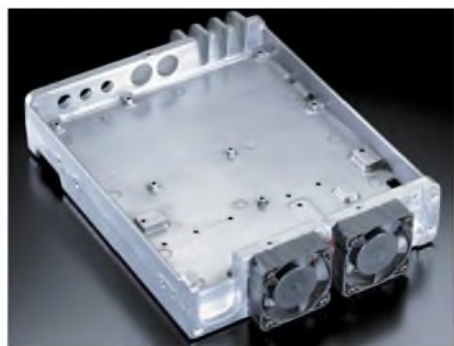
Bild 6: Das Chassis aus Druckguss-Aluminium ist für die Wärmeverteilung und -ableitung wichtig. Zwei kräftige Lüfter sorgen für Durchzug ... Fotos: DJ1TO (2), Werkfoto (4)
