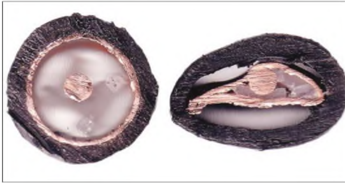
Luftisoliertes Koaxialkabel mit 16 mm Außenleiterdurchmesser – stark deformiert. Nähere Erläuterungen im Beitrag Fotos: DL5YY
