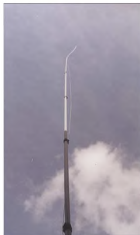
Bild 2: Vertikalantenne aus Kupferlitze an einem Glasfaser-Portabelmast mit aufgesetztem PVC-Rohr
