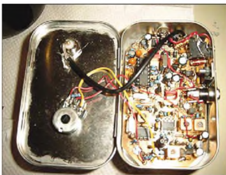
Innenansicht des QRP-Minitransceivers „Miss Mosquita“. Fotos: DJ8LD
