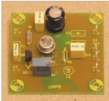
Bild 48: UAP 5, verschaltet als einstellbare, gepufferte Referenzspannungsquelle für viele Anwendungsmöglichkeiten Fotos: DG9WF
