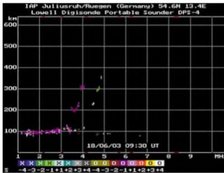
Bild 6: Ionogramm des Observatoriums Juliusruh/Rügen während eines Magnetsturms am 18. Juni 2003, der die F-Region in Höhen über 200 km nahezu völlig zerstörte. Ursache war das Eintreffen solarer Teilchen (CME) aus dem X-Flare vom 15. Juni im Zusammenspiel mit dem einsetzenden Wind aus einem koronalen Loch. Foto: Observatorium Juliusruh/Rügen
