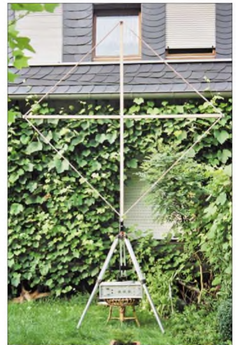
Bild 61: ELF-Empfänger mit Rahmenantenne, aufgebaut mit dem UAP-System. Die Antennenspule hat eine Seitenlänge von 2 m und ist mit 8 km Kupferlackdraht bewickelt.
