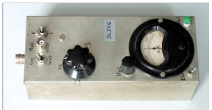
Bild 14: Das dritte Gerät verfügt über ein Messinstrument, bei dem der Nullpunkt in der Mitte liegt.
