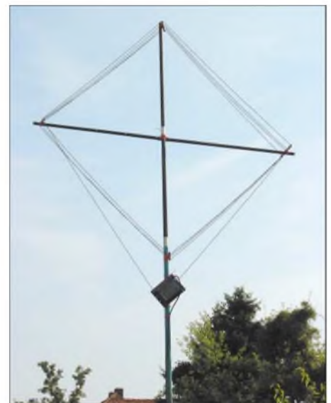
Bild 5: Die quadratische Vierer-Schleife im Einsatz, Seitenlänge 1,52 m, Diagonale 2,17 m Fotos: DK7ZB
