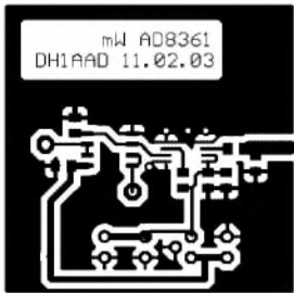
Bild 5: Layout des Messwandlers mit dem AD8361. Die Abmessungen der Platine betragen 35 mm x 35 mm.
