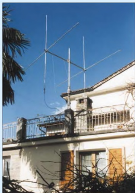
Bild 4: Quadantennen sind für die oberen Bänder (hier 10 m) eine gute Wahl; auf den unteren Bändern muss bei den meisten eine Drahtantenne herhalten. Foto: HB9ANR
