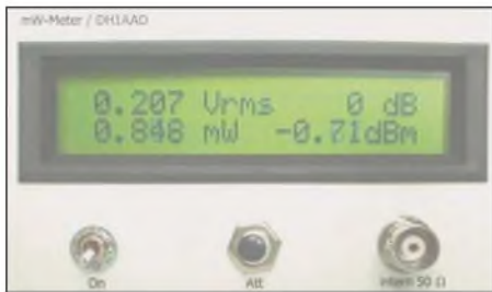
Bild 1: Durch das große LC-Display ist die gleichzeitige Anzeige des Messwertes als Effektivspannung und Leistung in mW und dBm möglich.
