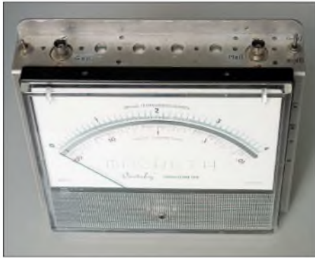
Bild 12: Frontansicht des zweiten Geräts; hierbei kam ein vorhandenes, „ausgeschlachtetes“ Messinstrument zum Einsatz.
