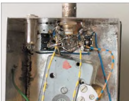
Bild 17: Ganz kurze Anschlüsse zu den Brückenelementen sind beim dritten Gerät ein Muss. Die Germaniumdioden sind in Kelchfedern gesteckt und nicht gelötet.
