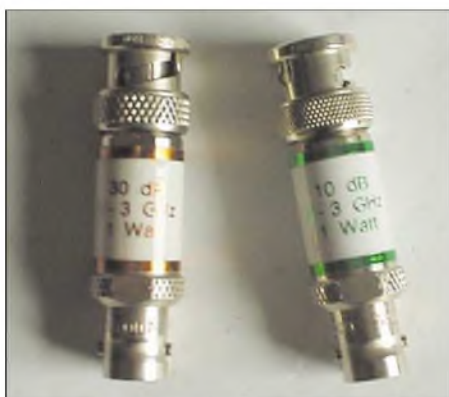
Bild 2: Für die Messung müssen aufgrund der geringeren maximalen Eingangsleistung Dämpfungsglieder vorgeschaltet werden.
