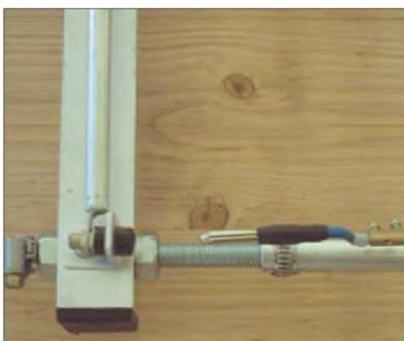
Bild 7: Steckbarer Übergang der Phasenleitung vom Boom zum Reflektor
