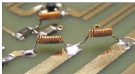
Bild 2: Die auf den Schaft eines Bohrers gewickelten Viertelwellendrosseln sind mit einem kleinen Abstand zur Platine einzulöten.
