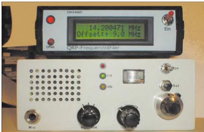
Bild 1: Der Prototyp des Zählers zeigt bei seinem Einsatz über einem QRP-Transceiver seine wahre Größe.
