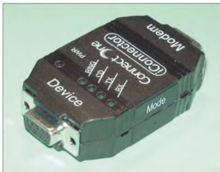
Bild 3: Mit dem iConnector kann sich ein beliebiges Gerät über handelsübliche Modems ins Internet einwählen.
