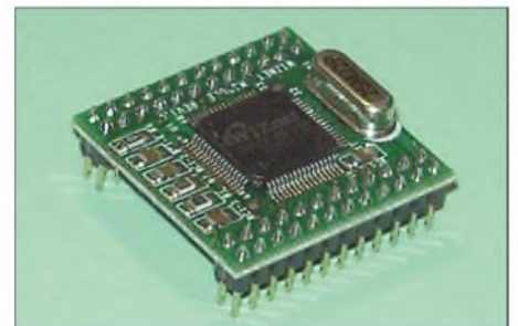
Bild 5: Das einfachste der vorgestellten Module zur Integration in eigene Applikationen ist das IIM7000.
