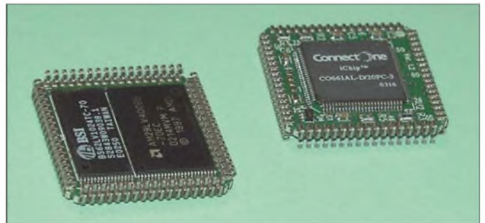
Bild 7: Die Module der iChip-Serie von Connect One besitzen eine PLCC-Bauform. Sie sind für Ethernet und für Wählverbindungen verfügbar.
