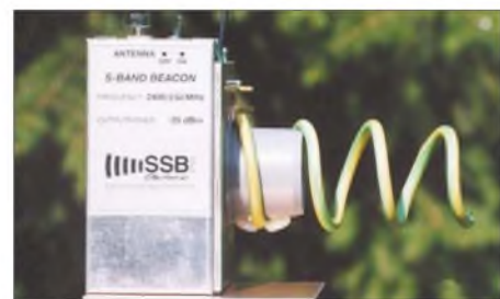
Bild 13: Kommerziell hergestellter Bakensender für 2400 MHz
