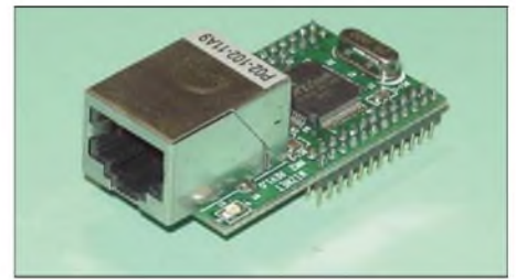
Bild 8: Beim IIM7010 ist bereits eine Buchse auf der Platine zur Verbindung mit Ethernet-Netzen vorgesehen.
