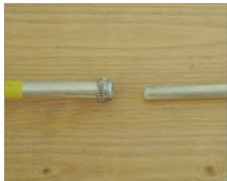
Bild 5: Bearbeiteter Übergang von 12 mm auf 10 mm Aluminiumrohr Fotos: DL3MCO
