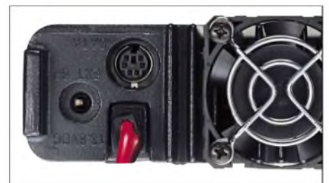
Bild 5: Rückseite mit Buchse für den externen Lautsprecher und Mini-DIN-Buchse für Packet-Radio. Fotos: Vertex Standard
