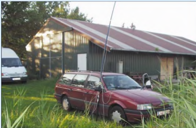
Die Angelruten-Vertikalantenne – auch portabel eine gute Wahl. Hier kommt sie als Mehrbandvariante mit Antennentuner am Fußpunkt zum Einsatz.
