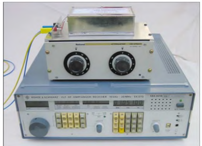
Bild 4: IM-Messgenerator (oben) mit Dämpfungsglied bei einer Messung des Interzeptpunkts des R&S EK070
