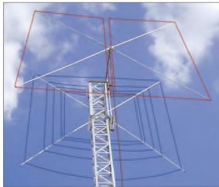
Bild 5: Aufbau der Quad in klassischer Quadratform, Drähte hier der besseren Erkennbarkeit halber rot (Strahler) bzw. blau (Reflektor) koloriert. Fotos: DL1DTC
