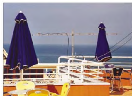
Die 9-Ele.-Yagi für 2 m Richtung DL auf der Hotelterrasse. Fotos: DL6LAU
