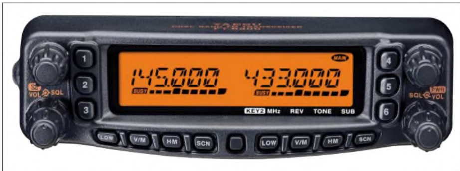
Bild 1: Bedienelemente sind mittensymmetrisch angeordnet. Eingeschaltet wird der FT-8800E durch 2 Sekunden langes Drücken auf den rechten Lautstärkeregler.
