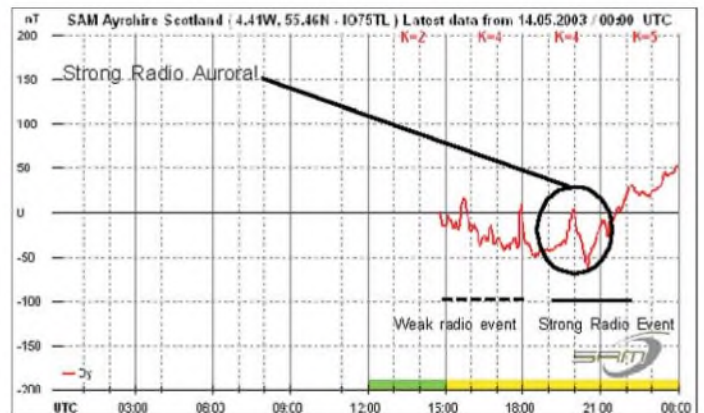
Bild 5: Beim Auswerten von Magnetogrammen sollte man, wie bei dieser schwachen Aurora, auf plötzliche Änderungen achten.
