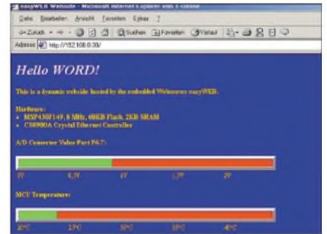
Bild 2: Die Software in der EasyWeb-II-Baugruppe erzeugt eine HTML-Seite, die im Netzwerk über einen Web-Browser abgerufen werden kann.
