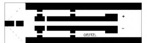
Bild 2: Das Layout des HF-Tastkopfes auf FR-4 Leiterplattenmaterial verdeutlicht die abzuschneidenden Ecken.
