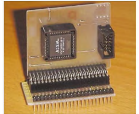
Bild 12: Die Buchse auf dem Entwicklungsboard gestattet das Abtrennen des Programmiers nach dem Beschreiben des FPGAs. Fotos: OE1RIB
