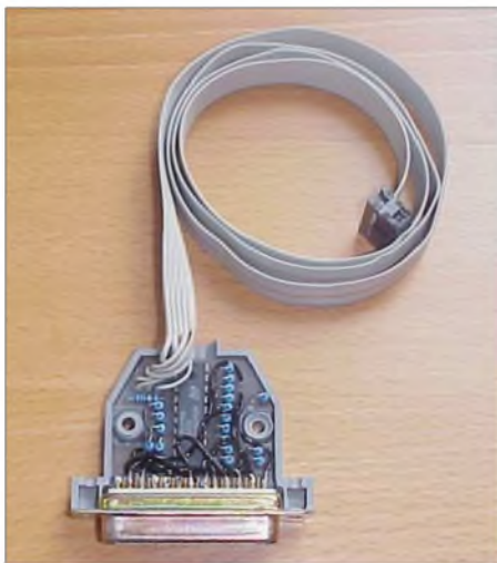
Bild 4: Der selbstgebaute JTAG-Programmer im LPT-Stecker ist kompatibel zum ByteBlaster MV von Altera.
