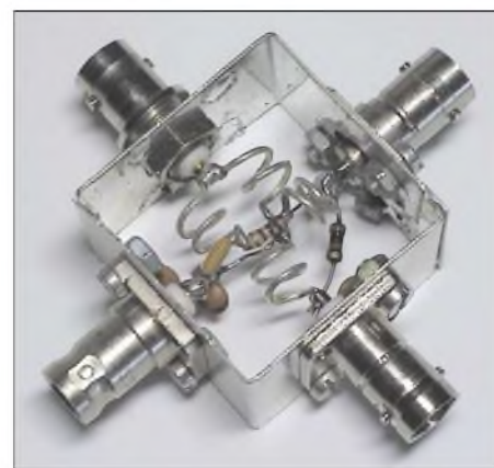
Bild 18: Versuchsaufbau eines Wilkinson-Teilers „1 auf 3“
